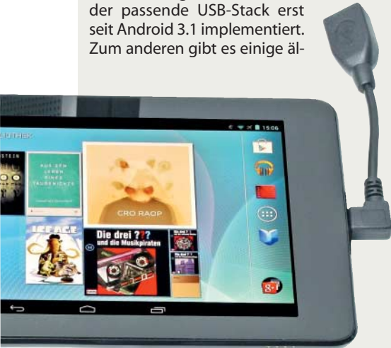
Ein Adapter mit Micro-USB-Stecker und USB-A-Buchse ermöglicht den Anschluss von USB-Massenspeichern an Tablet und Smartphone.
