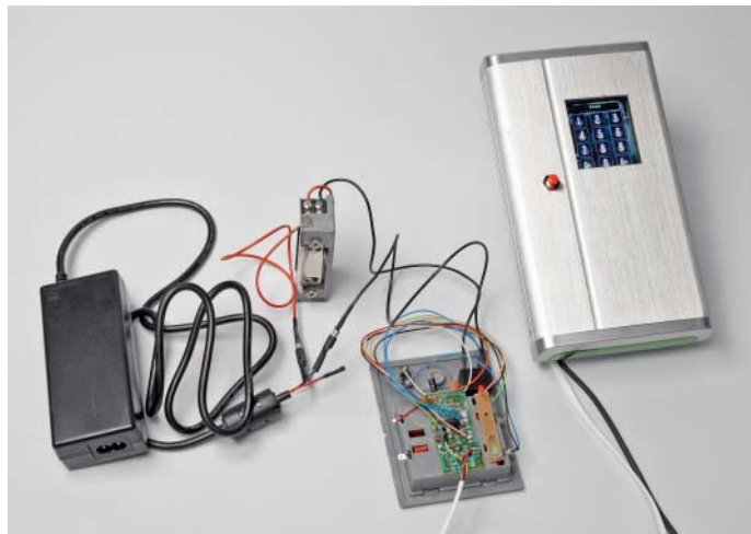
Das Netzteil links versorgt den elektrischen Türöffner gleich nebenan, der über ein Relais von der Tresorelektronik (Mitte) angesteuert wird. Rechts das Gehäuse mit eingebautem Smartphone, Fotodiode und Taster.
