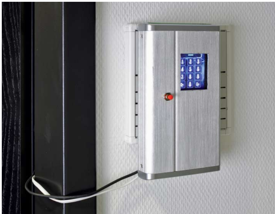
Das fertige Smart Lock: Die Kabel werden einfach durch den Türspalt nach innen geführt, das Gehäuse selbst an der Zarge oder unmittelbar daneben befestigt.
