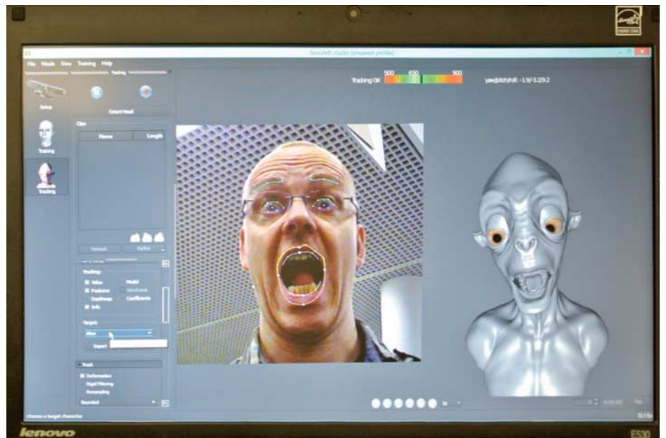
Facelift erkennt mit der PrimeSense-Kamera Gesichter und überträgt in Echtzeit die Mimik auf 3D-Figuren.
