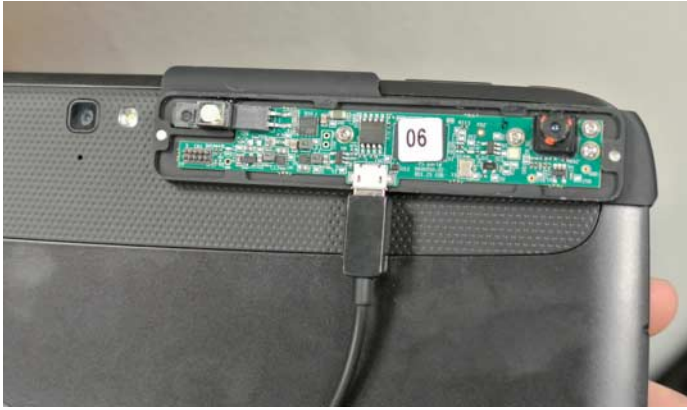
PrimeSense hat seine 3D-Kamera so weit geschrumpft, dass sie in Tablets und Smartphones passt.
