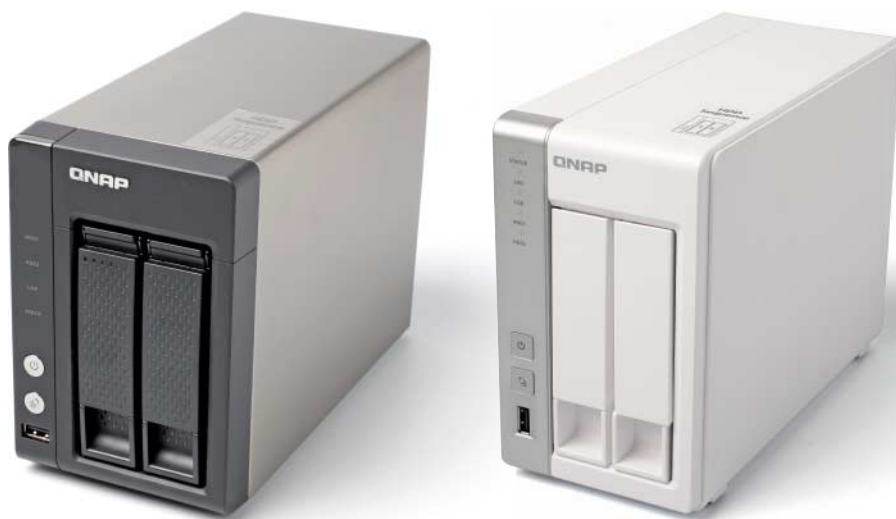
Die Schwestermodelle TS-220 (rechts) und TS-221 (links) von Qnap unterscheiden sich außer in der Farbe auch in der Hardware-Ausstattung: Mit stärkerem Prozessor und größerer RAM-Ausstattung ist das TS-221 besser für viele Zusatz-Apps gerüstet.
