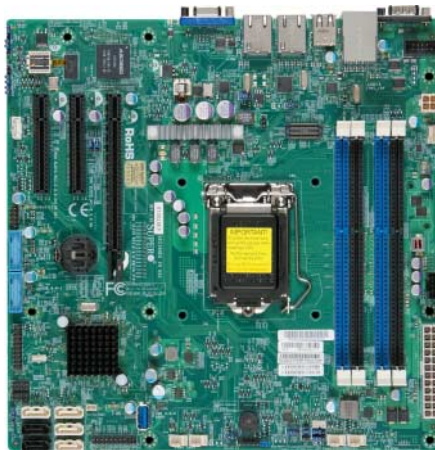
Das X10SLM-F bestückt Supermicro mit einem BMC-Chip von Aspeed.
