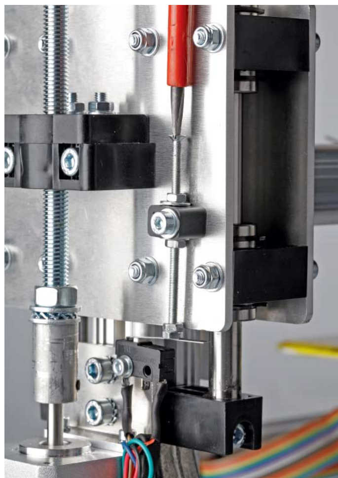
Die Einstellschraube für die z-Achse ist extrem wichtig. Sie sollte von oben einstellbar und gut befestigt sein. Hier empfiehlt es sich, von der Bauanleitung abzuweichen und zusätzliche M3-Muttern einzusetzen.
