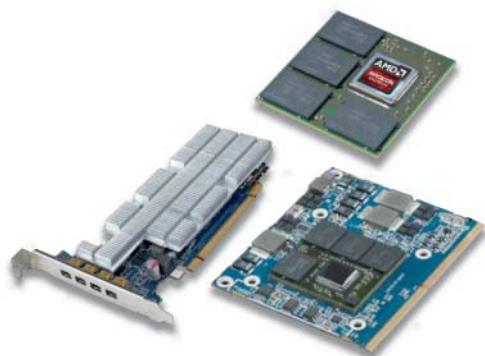
Die Embedded-Grafikeinheit Adelaar will AMD in drei verschiedenen Bauformen anbieten: PEG-Karte (links), Mobile PCI Express Module (MXM, rechts) und Multi-Chip-Modul (MCM, oben).
