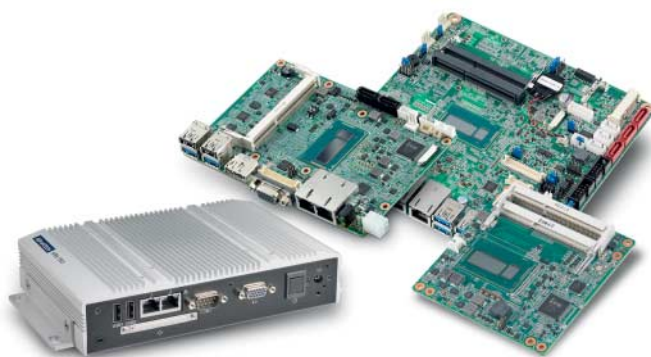
Advantech bietet Industrie-Boards und Computer mit Haswell-Prozessoren in diversen Formaten an: Während man mit dem lüfterlosen Box-PC, dem 3,5"- und dem Mini-ITX-Board (links hinten) sofort loslegen kann, erfordert das COM Express Modul (links) eine spezielle Basisplatine.
