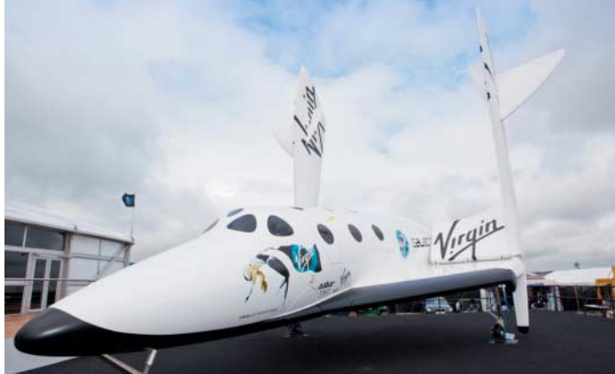
So sieht das SpaceShipTwo später in der „Feather Configuration“-Phase aus. Die hochgestellten Flügel bremsen die Maschine beim Fall durch die Atmosphäre ab.
