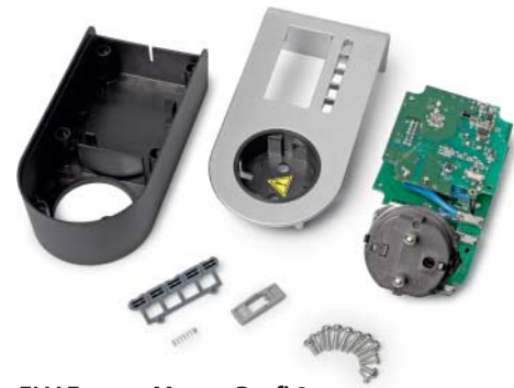
ELV Energy Master Profi 2: Bausatz zum Selbstmontieren, überraschte mit exzellenter Übereinstimmung zum Referenzgerät
