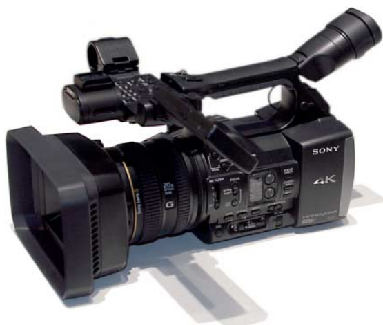
Camcorder für Ultra-HD-Auflösung: Der Sony FDR-AX 1 speichert Videos mit maximal 3840 × 2160 Pixeln.
