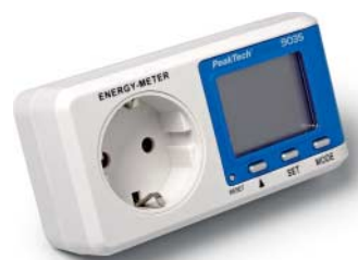
PeakTech 9035: problematisch mit Energiesparleuchte als Testlast, aber sonst geringer Messfehler
