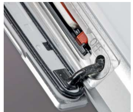
Wenn gar nichts mehr geht: Neben dem Einschub für die SIM-Karte hat Sony einen Reset-Knopf versteckt.
