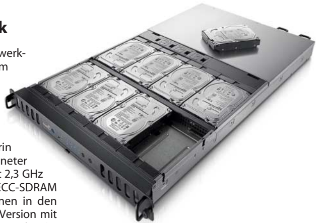
Acht Festplatten auf einer Höheneinheit in Seagates neuem Rack-NAS
