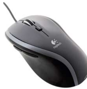
Logitechs Kabelmaus M500 (25 Euro) tastet den Untergrund per Laser ab.
