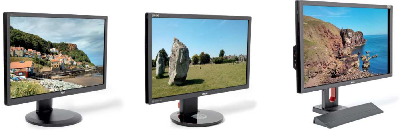
AOCs g2460Pqu nahm über DisplayPort kein 120-Hz-Signal entgegen, per Dual-Link-DVI klappt es aber reibungslos.
