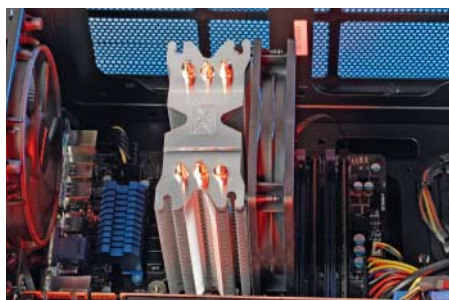
Unterschiedliche Kühlkonzepte: Ein kompakter Tower-Kühler von Mifcom ermöglicht leichten Zugriff auf die RAM-Riegel.
