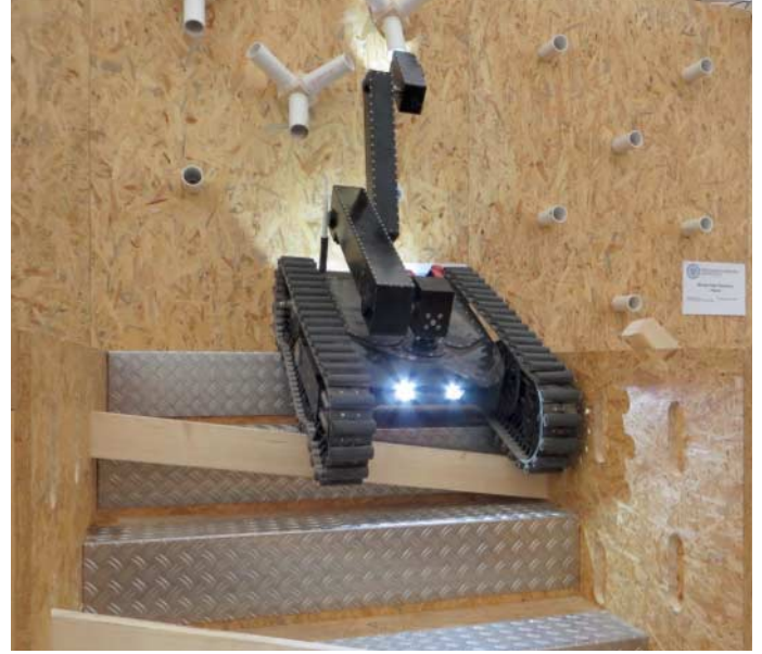
Ein Roboter der österreichischen Firma Taurob, der auch von der Wiener Feuerwehr verwendet wird, erprobt die NIST-Testverfahren, die in einer Ecke des Eurathlon-Veranstaltungszeltens aufgebaut waren.
