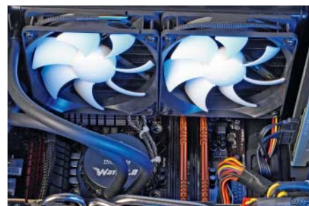
Die Wasserkühlung von Ultraforce macht gehörig Krach und hat trotzdem mit stark übertakteten CPUs ihre liebe Not.
