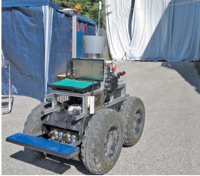
Der Roboter des Teams RIS (Toulouse) sollte sich mit Hilfe seines Laserscanners autonom durch einen mit Rauch gefüllten Tunnel tasten, kam aber nur etwa fünf Meter weit. Die Rauchpartikel erzeugten zu viele Reflexionen.
