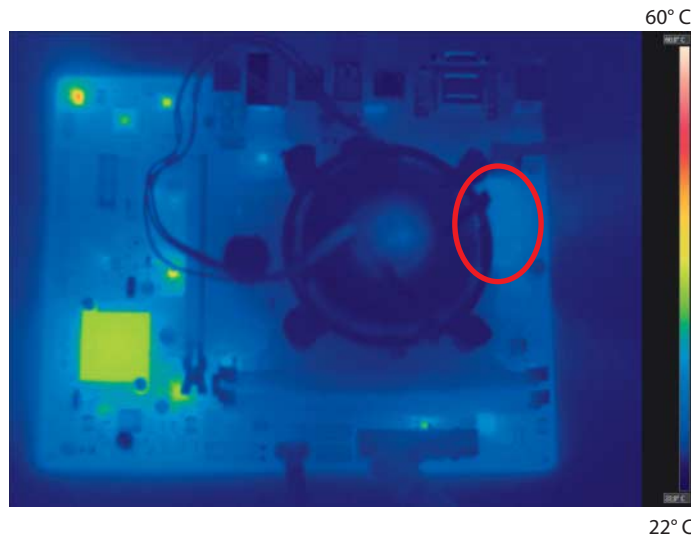
Das sparsamste und energiehungrigste Board im Vergleich: Beim Asrock bleiben die Spannungswandler unter 35 °C, ...
