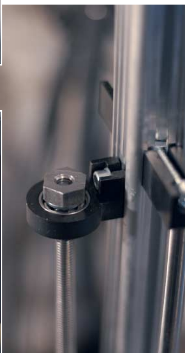
Die klobigen Trapezgewinde-Muttern kann man einfach durchsägen und gewinnt dann zwei handliche Muttern für die obere Befestigung der Trapezgewinde-Spindel.
