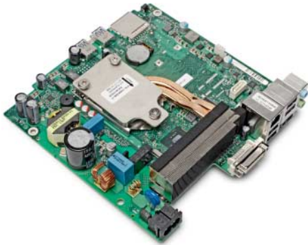
Der Esprimo Q520 ist unter anderem deshalb so sparsam, weil Fujitsu das Netzteil direkt auf der Platine integriert.
