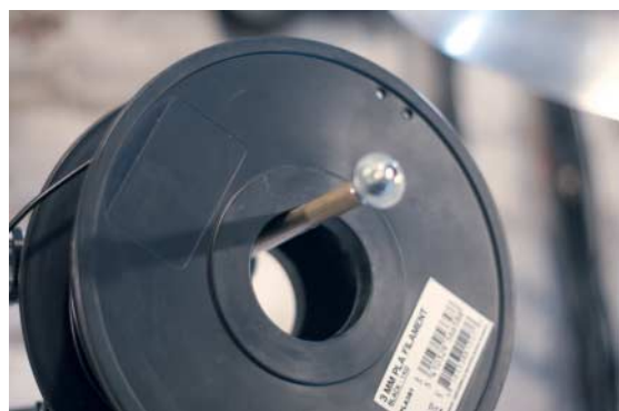
Ein kleines Rohr über der Gewindestange des Rollenhalters sorgt für leichten Nachschub und verhindert, dass sich die Rolle mit der Zeit vom Halter herunterschraubt.
