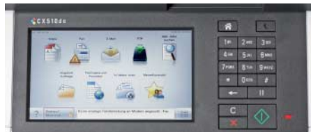
Großanzeige: Mit knapp 18 Zentimetern Diagonale bietet der Lexmark CX510 dhe den größten Touchscreen im Test, das Menü ist an eigene Wünsche anpassbar.
