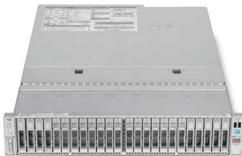
In den Sun Server X4-2L packt Oracle bis zu 24 Festplatten.
