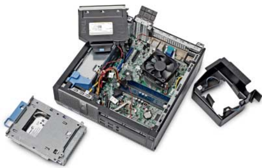
Ungleiche Gegner: Dell bekommt beim Optiplex 9020 SFF gute Wartbarkeit und ein kompaktes Gehäuse unter einen Hut.
