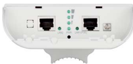
Der DAP-3310 von D-Link hält widriges Wetter aus und bezieht Strom aus dem Ethernet-Kabel.
