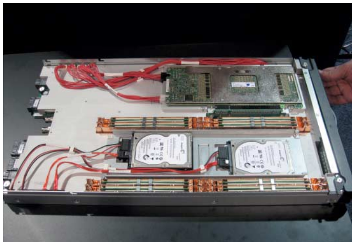
Bull baut den Petaflops-Rechner fürs ZIH Dresden mit Direct Liquid Cooling. Auch Nvidias neue Tesla-K40 (oben, über den Festplatten) passt bereits in den massiven Metallkühlkörper hinein.
