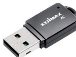
Der EW-7811UTC von Edimax überträgt im 5-GHz-Band bis zu 433 MBit/s.
