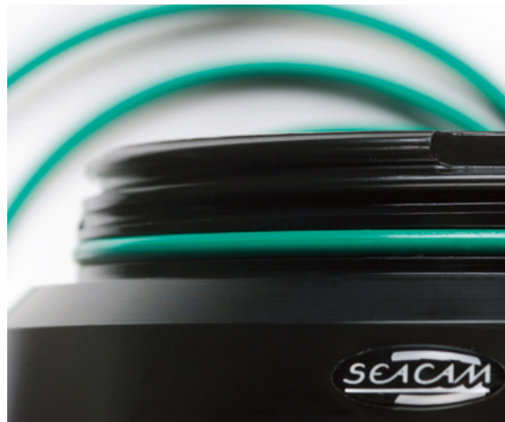
Jeder Front-Port hat einen O-Ring, der ebenfalls gut gepflegt werden muss, damit kein Wasser ins Gehäuse eindringen kann. ©Seacam
