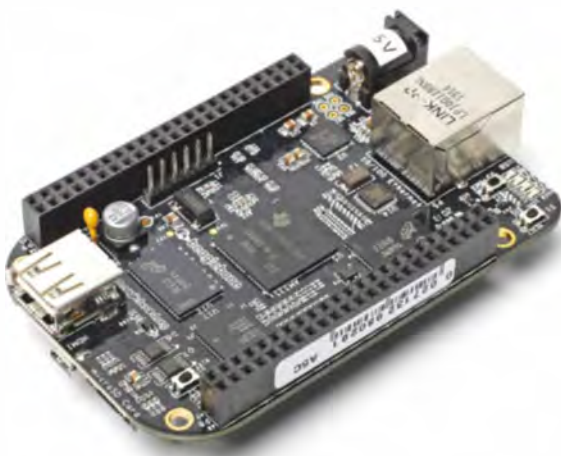
Das BeagleBone Black wird mit einem vorinstallierten Angström-Linux ausgeliefert und bringt eine JavaScript-Bibliothek mit, über die sich aus dem Browser heraus mit wenigen Klicks die I/O-Pins ansteuern lassen. Das macht den Einstieg besonders leicht.
