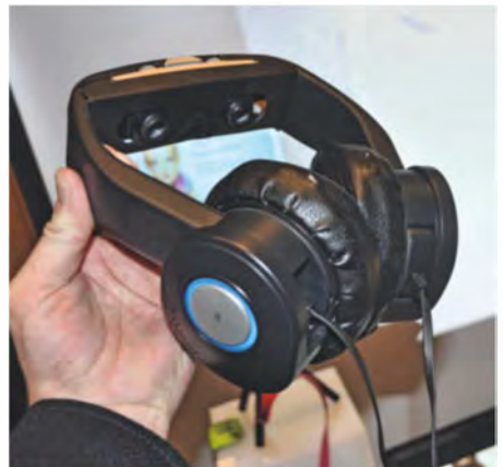
Die Projektorendisplays der Avegant-Glyph-Videobrille stecken im Kopfhörerbügel.
