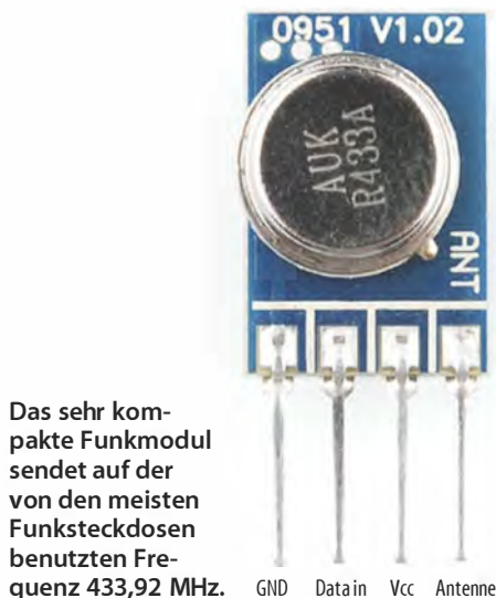
Drei Kabel genügen, um den Raspberry funktauglich zu machen.
