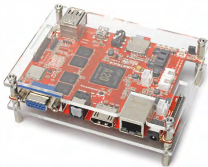
Mit leistungsfähigem Doppelkern-Prozessor, SATA-Schnittstelle und Gigabit-Ethernet-Anschluss ausgestattet ist der Cubietruck eine gute Basis für ein NAS, eignet sich dank Hardware-Video-Decoder, HDMI- und Audio-Anschlüssen aber auch als Mediacenter.
