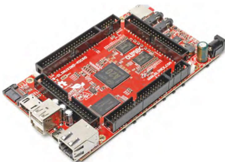
Über die ringsum angeordneten Erweiterungsanschlüsse kann der OLinuXino Micro A20 mit einem 13-Zoll-Touchscreen ausgestattet werden, außerdem verfügt er über einen Akku-Anschluss und lässt sich aus dem Auto-Bordnetz mit Strom versorgen.
