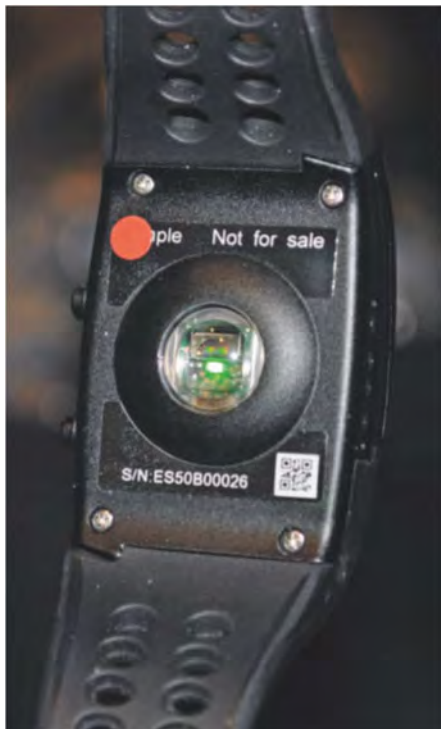
Eine grüne LED in Epsons Aktivitäts-tracker-Armband PS-100 durchleuchtet zur Pulsmessung die Haut.
