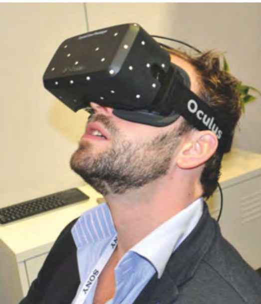
Erstmals mit Positional Tracking, das die Position im Raum erfasst: der neue Prototyp der Virtual-Reality-Brille von Oculus
