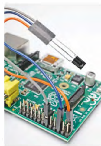
Drei Kabel und ein IR-Empfänger rüsten den Raspberry Pi für den Einsatz einer Infrarot-Fernbedienung.
