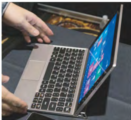
Das Lenovo Miix 2 hält magnetisch an der Tastatur. Es gibt eine 10-Zoll-Version mit Atom sowie eine mit 11,6 Zoll und Core i5.
