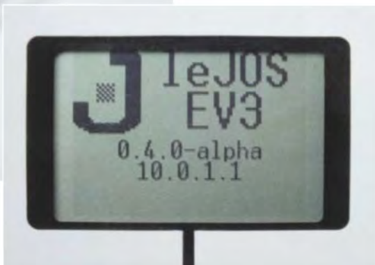
War der Bootvorgang von Karte erfolgreich, zeigt LeJOS seinen Schriftzug an. Zusätzlich gibt es die IP-Adresse aus, unter der der Brick erreichbar ist.
