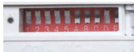
Bei den Pollin-Dosen sind die Gerätecodes als Buchstaben kodiert. A steht für 1, D für 4.
