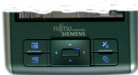
Abbildung 2.2: Über dieses Bedienfeld verfügen praktisch alle Pocket PCs, es ist nur unterschiedlich gestaltet. (Beispiel: Fujitsu-Siemens PocketLOOX N520)
