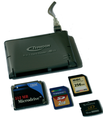
Abbildung 7.8: Mit einem zusätzlichen Speicherkartenleser (Cardreader) kann man die Datenübertragung erheblich beschleunigen; eine Auswahl an Speicherkarten: Microdrive/CF, SD, MMC, xD (von links nach rechts).
