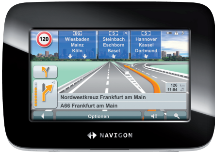
Abbildung 1.8: Bei den neuesten Geräten wie dem Navigon 7100 geht der Trend zur fotorealistischen Darstellung. (Bild: Navigon)
