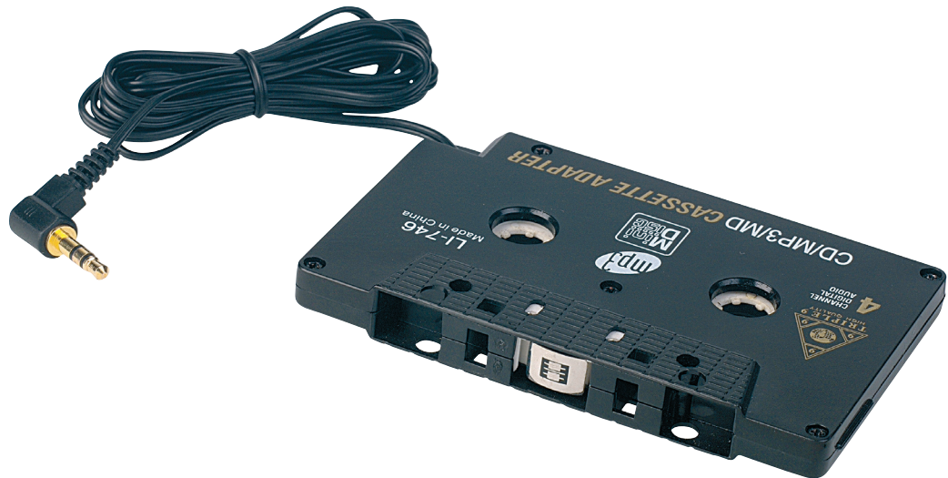
Abbildung 7.2: Es sieht aus wie eine Kassette, es ist aber keine – sondern ein Adapter zur Tonübertragung. (Bild: Pearl)
