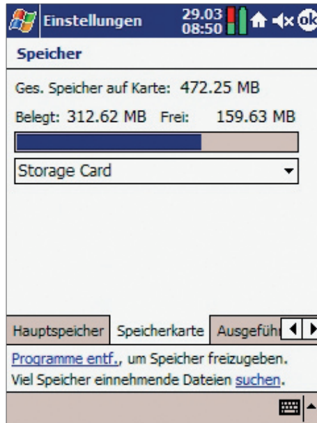
Abbildung 1.17: Über die Systemeinstellungen prüfen Sie die Belegung der zusätzlichen Speicherkarte („Storage Card“).
