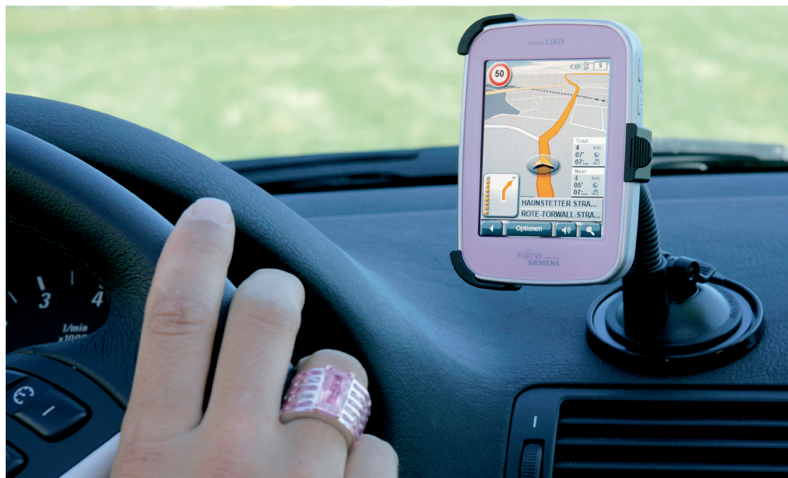
Abbildung 7.1: Alternativ zur Windschutzscheibe kann man den Saugnapf auch zusammen mit einem Träger für die Armaturentafel verwenden. (Bild: Fujitsu Siemens)
