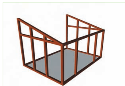
Abb. 5.10 – Jetzt können der vordere Querträger und die Frontständer eingepasst und montiert werden. Die Frontständer sind so anzuordnen, dass die zukünftige Tür je nach Art und Abmessung problemlos eingefügt werden kann. Die Oberseite des Querträgers ist entsprechend der Dachneigung schräg abzuhebeln oder zu sägen.
