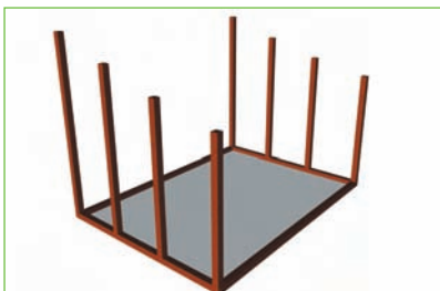
Abb. 5.7 – Es folgt die Montage der Giebelständer, die Längen werden in etwa dem Dachwinkel entsprechend abgesägt. Man sollte bei der Hauswand anfangen und die Giebelständer mit ihr verschrauben. Entsprechend des vorgesehenen Rasters werden auf der Giebelseite die Ständer gesetzt. Bei den Ständern überprüft man mit der Wasserwaage die senkrechten Ausrichtungen (in zwei Ebenen). Mit provisorisch angeschraubten Dachlatten werden die Ständer ausgerichtet und fixiert.
