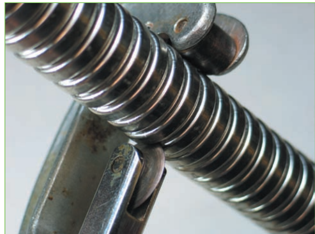
Abb. 5.4 – Flexrohr für die Heizungsanbindung (beim Ablängen).
