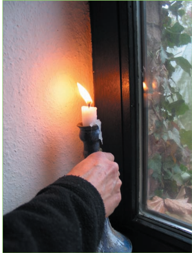
Abb. 4.3 – Einfacher Luftzugtest mit Kerze.
