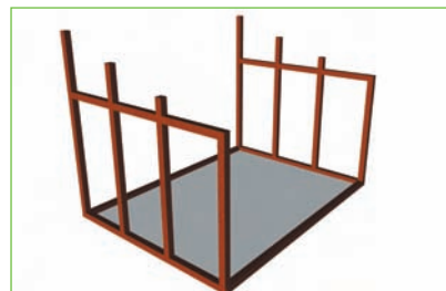
Abb. 5.8 – Nun wird die Lage der Quersprossen, beginnend an der Hauswand, angezeichnet. Mithilfe von Nageleisen (Winkel) und Schrauben (mit Akkuschrauber) werden die Quersprossen dazwischen angeordnet. Die Quersprossen sollen waagrecht in der richtigen Höhe eingebunden werden. Holzspezialisten können die Verbindungen auch zapfen oder überplatten.
