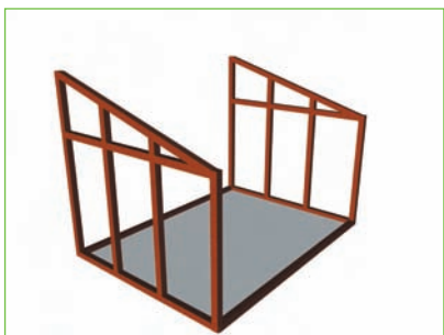
Abb. 5.9 – Im nächsten Schritt wird eine Schnur gespannt oder eine gerade Latte provisorisch vom Giebelständer (bei der Hauswand) zum Eckständer angeschraubt. Alle Ständer werden oben angezeichnet. Die Ständer (evtl. demontieren) sind entsprechend der angezeichneten Dachschräge abzusägen. Nun können die Sparren (Randsprossen) auf den schräg abgesägten Giebelständer aufmontiert werden. Auch die Enden der Sparren sind vorher entsprechend des Dachwinkels schräg abzusägen.
