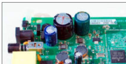
Kondensatorpest: Der mittlere Kondensator auf dieser Router-Platine zeigt mit aufgeblähtem und ausgelaufenem Elektrolyt die typischen Symptome.
