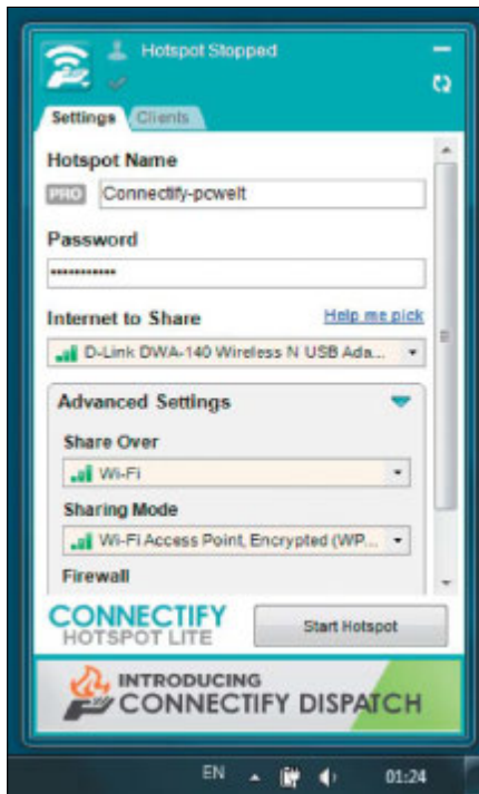
Das Notebook als Hotspot und WLAN-Router: Connectify verwandelt den PC in einen WLAN-Router, um eine kabelgebundene Internetverbindung mit anderen Geräten zu teilen.
