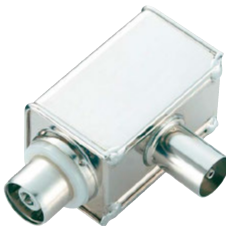
Ein Mantelstromfilter kommt zwischen Antennenkabel und TV-Karte. Er entkoppelt die Masseverbindung und verhindert so eine Brummschleife.
