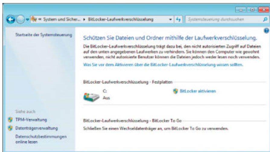
BitLocker: Diese Art der Laufwerksverschlüsselung ist in den Ultimate- und Enterprise-Versionen von Windows Vista und 7 enthalten. Dass sie selten zum Einsatz kommt, liegt an einem TPM-Chip als Standardvoraussetzung.
