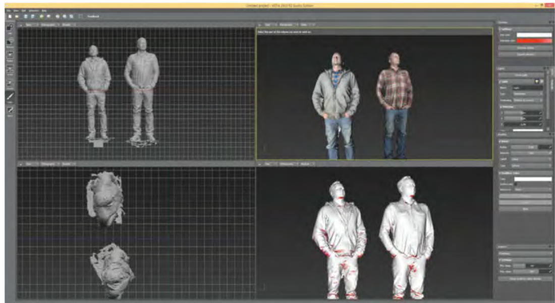
Die 3D-Modelliersoftware Vota verwandelt Polygonnetze, beispielsweise aus 3D-Scans, in solide Volumenmodelle.
