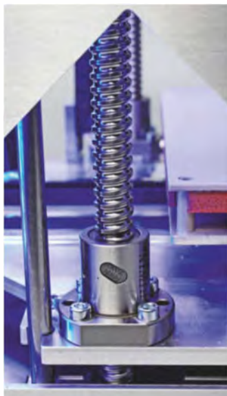
Die hochwertigen Kugelumlaufspindeln sorgen für eine präzise Steuerung der Schichtdicke beim 3D-Druck.
