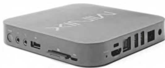
Der Cortex-A9 (Rockchip RK3066) im Minix Neo 5 lief unter Debian mit 1,2 GHz
