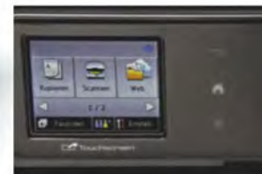
Staubschutz: Beim Brother DCP-J552DW verschwindet das Papier-vorratsfach im Gerät. Über den kleinen Touchscreen lässt sich der Drucker einfach bedienen – wichtig etwa für schnelle Fotokopien.
