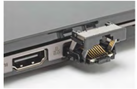
Der Netzwerkbuchse spendiert Fujitsu einen filigranen, aber stabilen Ausklappmechanismus.
