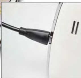
Die vorgezogene Kante des Q7-Gehäuses verhindert, dass normale Micro-USB-Stecker die Ladebuchse erreichen.
