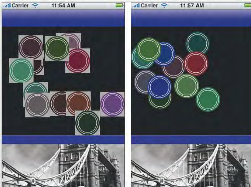
► Abbildung 8.2: Die Anwendung sollte Berührungen in den grauen Bereichen um die Kreise ignorieren (links). In der eigentlichen Oberfläche (rechts) werden Alpha-Werte von null verwendet, um die nicht verwendeten Teile der Ansichten auszublenden.
