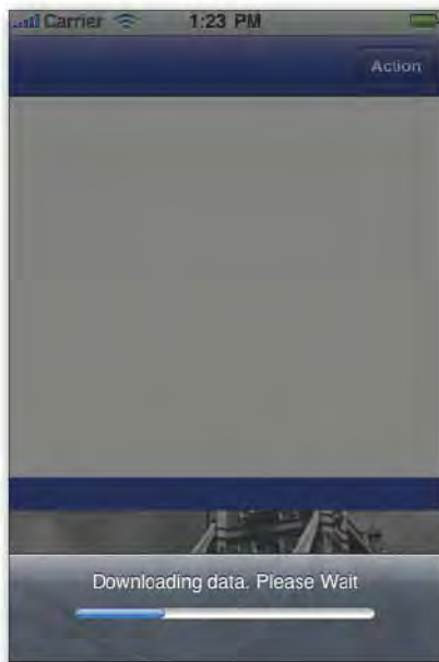
► Abbildung 10.6: Mit UIProgressView -Instanzen zeigen Sie den Fortschritt bei einer längeren Verzögerung an. Wenn Sie sie zu einem UIActionSheet hinzufügen, vereinfachen Sie ihre Darstellung und das Ausblenden.
