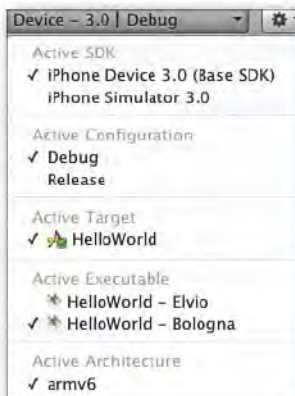
► Abbildung 2.17: Bei der Auswahl unter ACTIVE EXECUTABLE geben Sie an, welches Gerät verwendet werden soll. In diesem Beispiel sind an den Mac zwei Entwicklungseinheiten angeschlossen, wobei das Gerät mit dem Namen »Bologna« ausgewählt ist.
