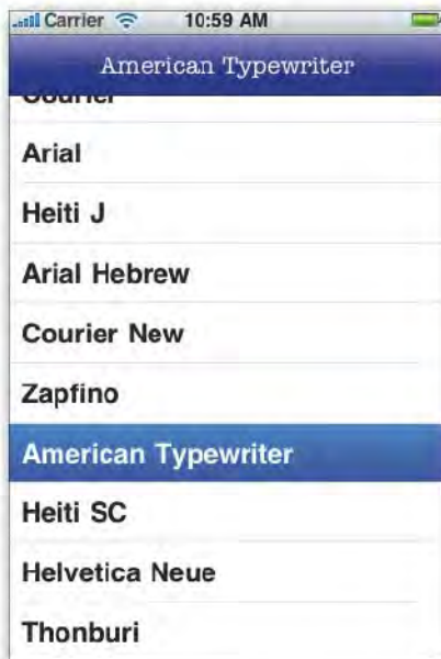
► Abbildung 11.1: Es ist einfach, eine UITableView aus einem Array mit Strings heraus mit Zellen zu füllen. Hier wird die Schriftartenliste der Klasse UIFont aufgeführt. Wird eine Schriftart angetippt, aktualisiert sich die Schrift der Titelleiste mit der ausgewählten Schrift.
