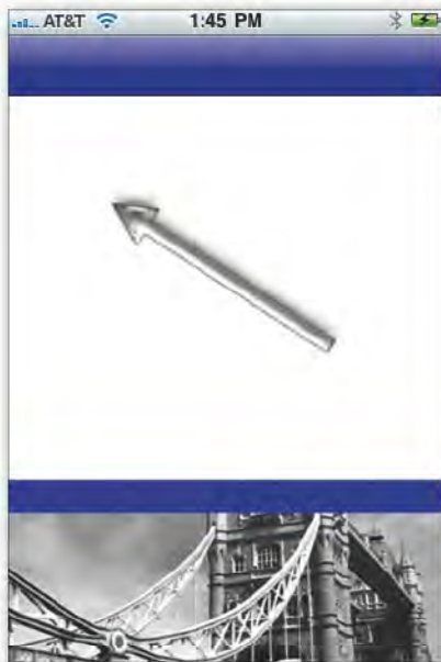
► Abbildung 14.2: Mithilfe von etwas Mathematik lässt sich ermitteln, wo »oben« ist, indem eine Arkustangens-Funktion unter Verwendung der Kraftvektoren x und y ausgeführt wird. In diesem Beispiel deutet der Pfeil immer nach oben, unabhängig davon, wie der Benutzer das iPhone hält.
