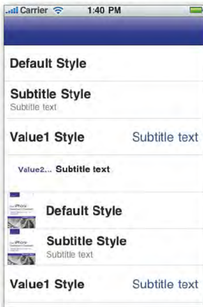
► Abbildung 11.3: Cocoa Touch bietet vier Standardzellentypen, in denen teilweise auch Bilder angezeigt werden können.
