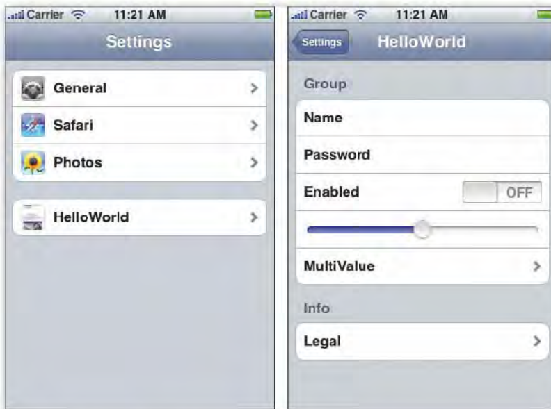
► Abbildung 21.3: Eigene Einstellungs-Bundles von Drittanbieteranwendungen erscheinen auf dem Bildschirm des Programms „Einstellungen“ hinter den mitgelieferten Einstellungen (links). Vom Entwickler definierte Elemente für Voreinstellungen können Textfelder (normale und sichere), Schalter, Schieberegler, Optionsschalter, Gruppentitel und untergeordnete Bereiche enthalten (rechts).
