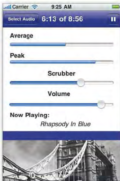
► Abbildung 15.1: Die in diesem Screenshot dargestellten Funktionen wurden einzig und allein mit der Klasse AVAudioPlayer eingerichtet. Sie ermöglicht die Anzeige der Wiedergabezeit (in der Mitte der Titelleiste), die Anzeige der Pegel (Durchschnitts- und Spitzenwert – AVERAGE und PEAK ), Schieberegler für die Wahl der Wiedergabeposition ( SCRUBBER ) und der Lautstärke ( VOLUME ) sowie Schaltflächen für Wiedergabe und Pause (rechts in der Titelleiste).
