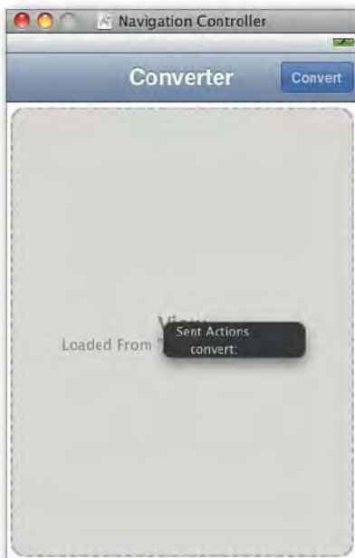
► Abbildung 4.11: Ziehen Sie eine Verbindung von dem Schaltflächenelement in der Leiste zur Mittelansicht, um die Schaltflächenaktion mit einer Methode zu verbinden, die vom Controller der Ansicht definiert wird.
