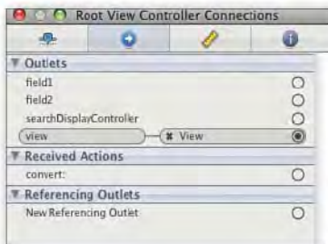
► Abbildung 4.10: Leere Kreise kennzeichnen Outlets und Aktionen, die noch nicht mit Objekten verbunden sind.
