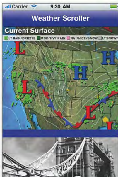
► Abbildung 7.5: Diese aktuelle Wetterkarte wird von einem URL im Web heruntergeladen und mit einer Rollansicht überlagert, die es dem Benutzer erlaubt, die Größe des Bildes zu ändern und sich durch die Anzeige zu bewegen.
