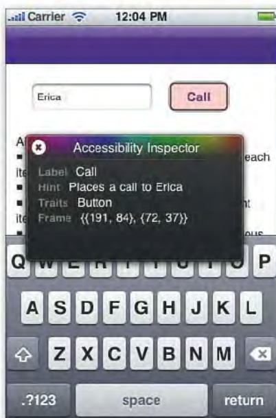
► Abbildung 21.2: Das Bedienungshilfen-Informationsfeld des iPhone-Simulators zeigt das zurzeit markierte GUI-Element mit seinem Label, seinem Hinweis und anderen Bedienungshilfen-Eigenschaften an.
