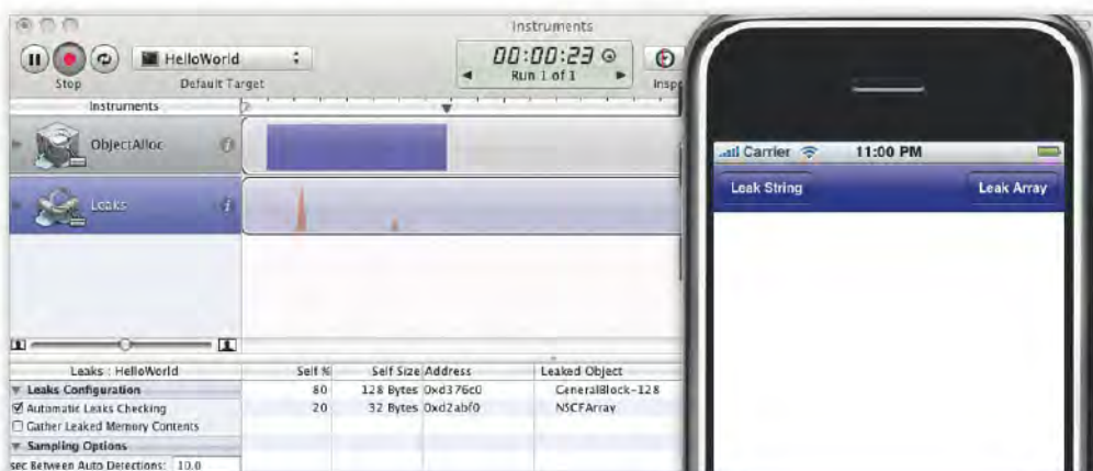
► Abbildung 2.11: Instruments verfolgt Leaks nach, also Speicher, der nicht wiedergewonnen werden kann.
