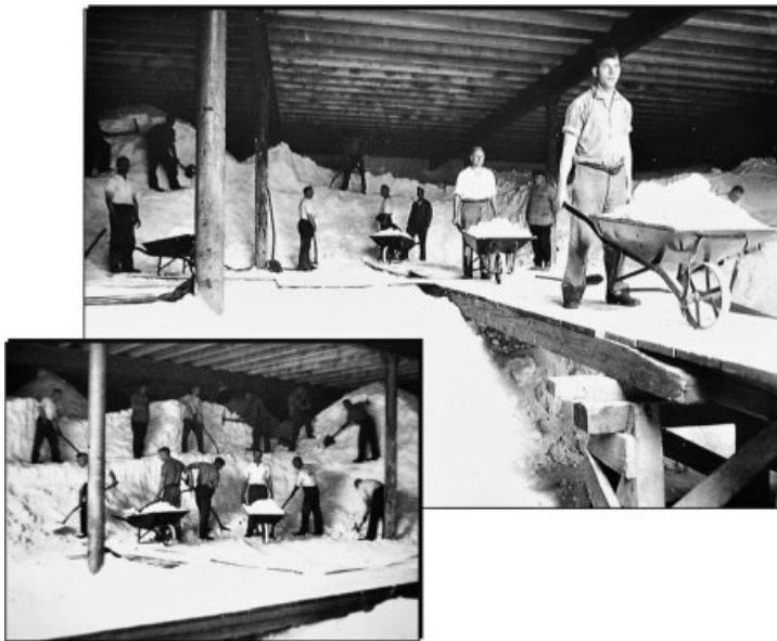
Abb. 7.1 Waschmittelherstellung nach dem Tennenvverfahren (um 1920).
