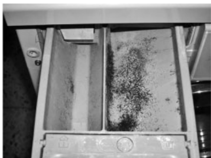
Abb. 8.31 Mit Schimmelpilzen belegte Einspülkammer einer Waschmaschine.
