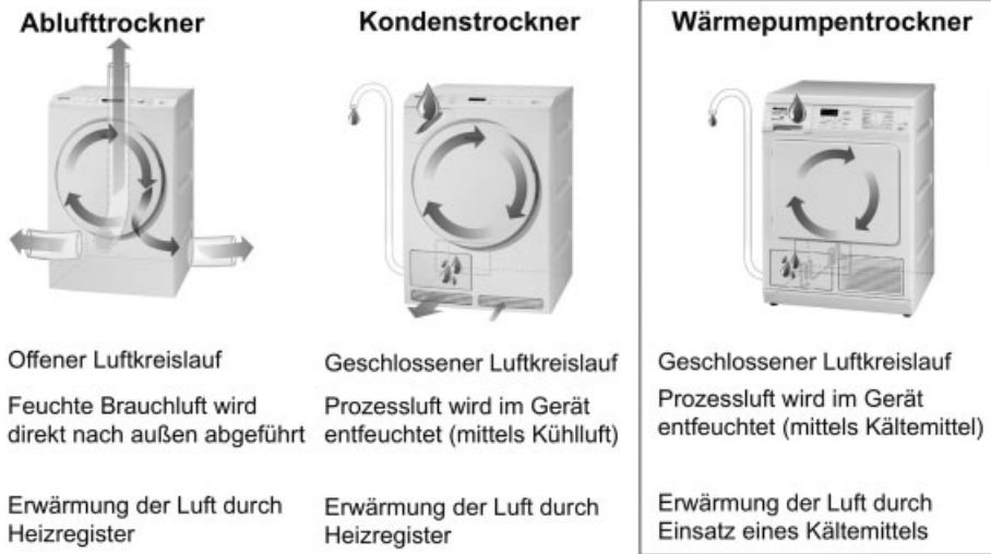
Abb. 1.27 Funktionaler Aufbau von Wäschetrocknern (Quelle: Miele).
