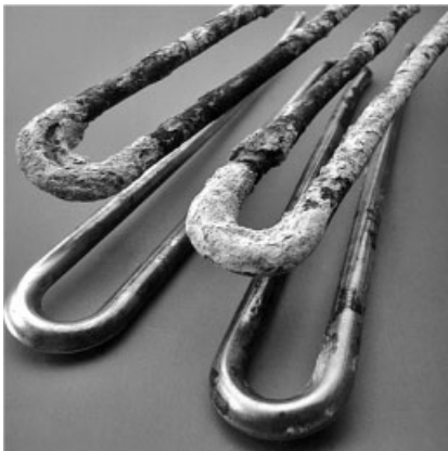
Abb. 5.2 Heizstäbe einer Waschmaschine. Neu (unten), verkalkt (oben).
