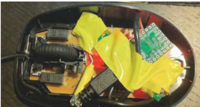
Derart manipulierte Mäuse mit zusätzlicher Elektronik bestehen keinen Test beim Sicherheitsbeauftragten.
