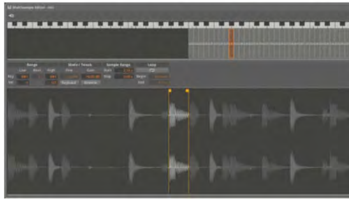
Der integrierte Multi-Sample-Editor zeigt an, wie die einzelnen Samples über die Tastatur- und Velocity-Bereiche verteilt sind.
