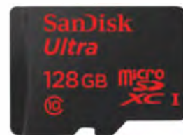
128 GByte Speicherplatz in 17 hauchdünnen Chip-Lagen: microSDXC-Karte von Sandisk
