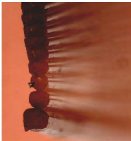
Unter dem Mikroskop (zirka 22-fache Vergrößerung) sieht man die einzelnen Schichten eines 3D-Druckes deutlich. Die erste Schicht ist etwas dicker. Wenn man den Drucker ordentlich kalibriert hat, stimmt die Breite der Filamentfäden mit den Vorgaben überein.
