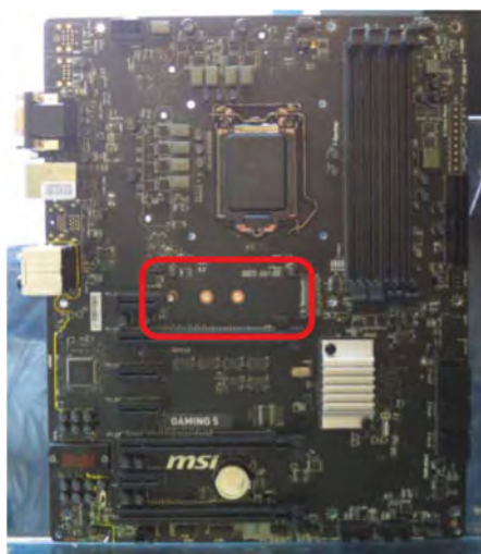
MSI Gaming 5: LGA1150-Mainboard mit m.2-Steckplatz (rot markiert)
