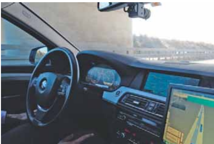
Hochautomatisiert über die Autobahn: Mit 120 km/h schwimmt der Testwagen im Verkehr mit, überholt langsamere Fahrzeuge und lässt andere an der Auffahrt einfädeln.
