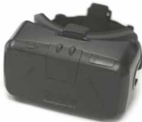
Die für Juli angekündigte Entwicklerversion der Oculus Rift hat ein schnelles OLED-Display und einen verbesserten Headtracker.
