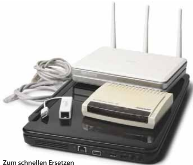
Zum schnellen Ersetzen eines unsicheren Routers genügen ein PC, eine zweite Ethernet-Schnittstelle und ein Modem.
