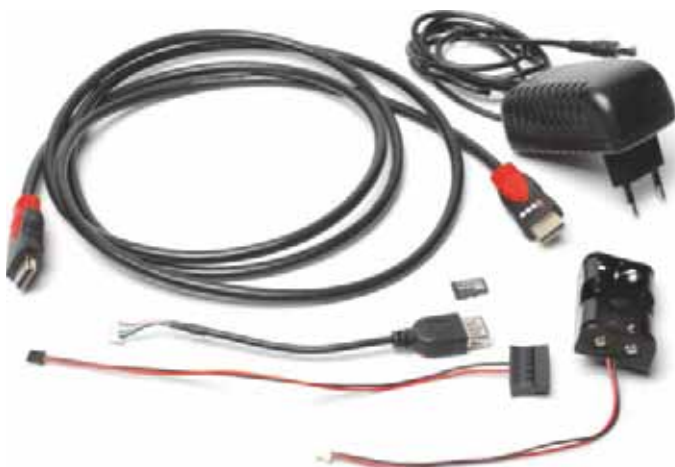
Das Starterkit mit Kabeln und Netzteil erleichtert den Einstieg in die Udoos-Welt und rüstet eine dritte USB-Buchse nach. Das Batteriepack versorgt die Echtzeituhr.
