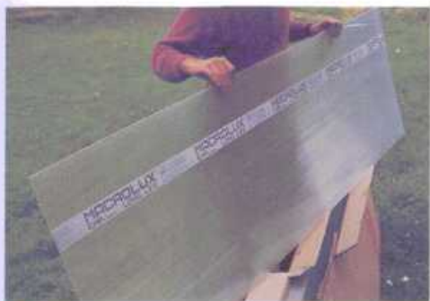
Stegdoppelplatten, auch Hohlkammerplatten genannt, sind aus Kunststoff
