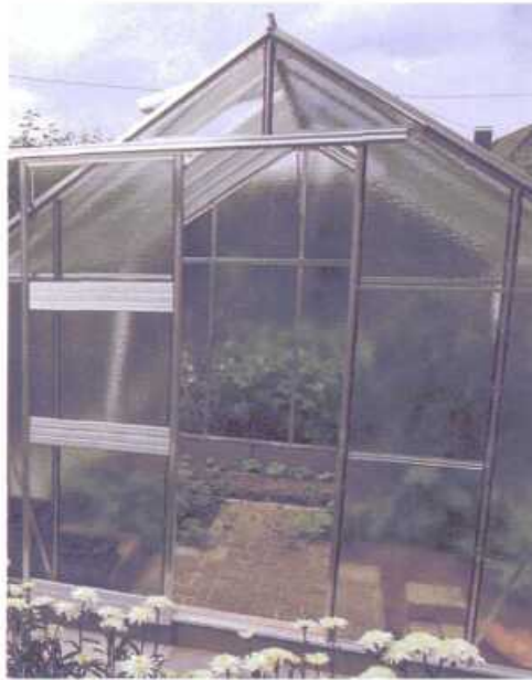
Schiebetüren sparen Platz, sie müssen aber sehr sorgfältig eingebaut werden, damit sie ausreichend dicht schließen
