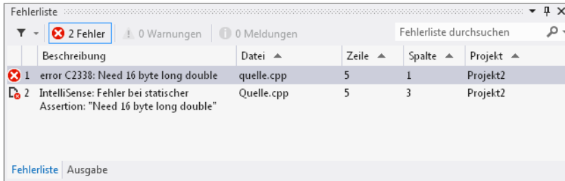
Abbildung 2.1 Beim Microsoft Visual Studio ist auf diesem Testsystem ein »long double« nicht 16 Bytes breit, und daher bricht der Compiler die Übersetzung dank unseres static_assert() ab.
