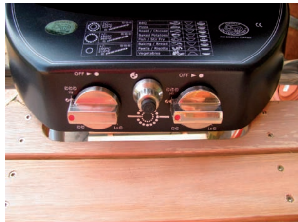
Im Knopf der elektronischen Zündung verbirgt sich die Batterie für den Zündfunken.
