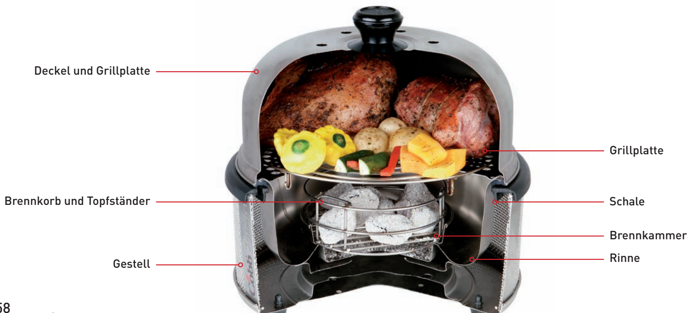
Fuktionsschema des Cobb Grills.
