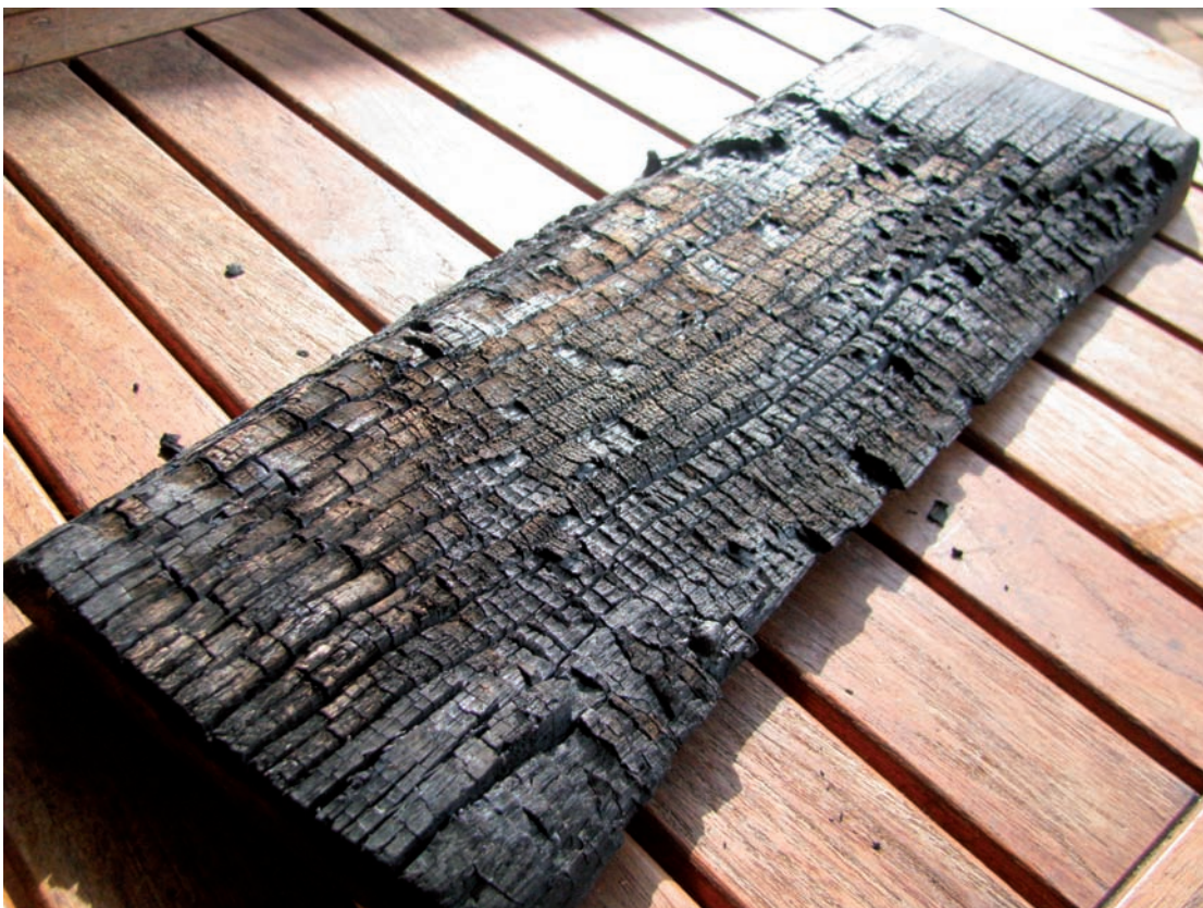
... wie gut an der verkohlten Unterseite zu erkennen ist. Trotzdem kann diese Planke noch einige Male verwendet werden.
