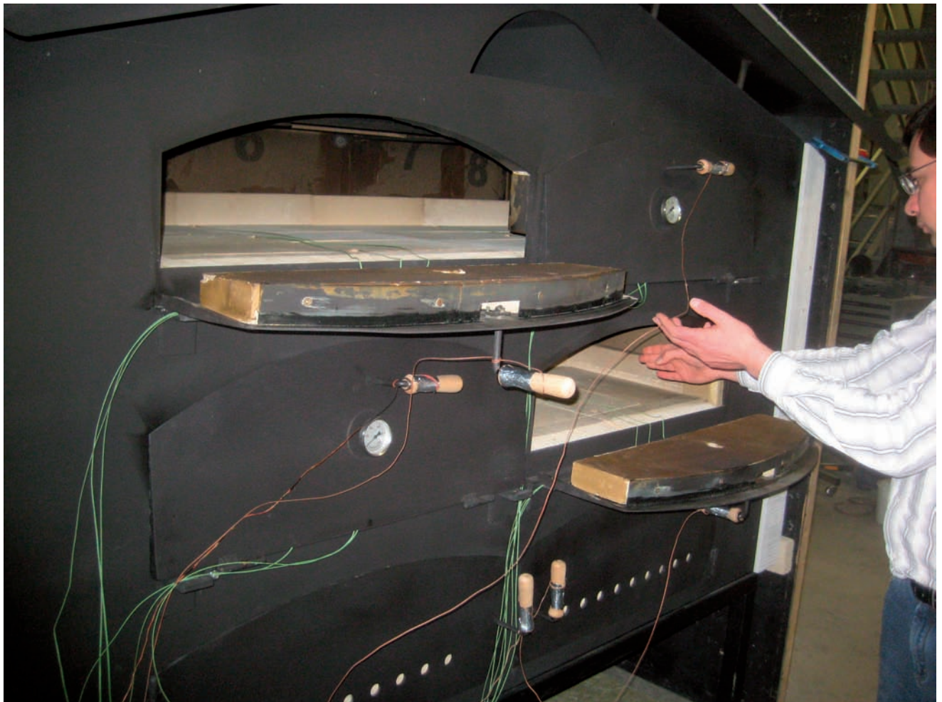
Messuntersuchungen im Fraunhofer Institut zur Bestätigung der quasi konstanten Temperaturen der Backkammern, die dieses Gerät einzigartig machen.
