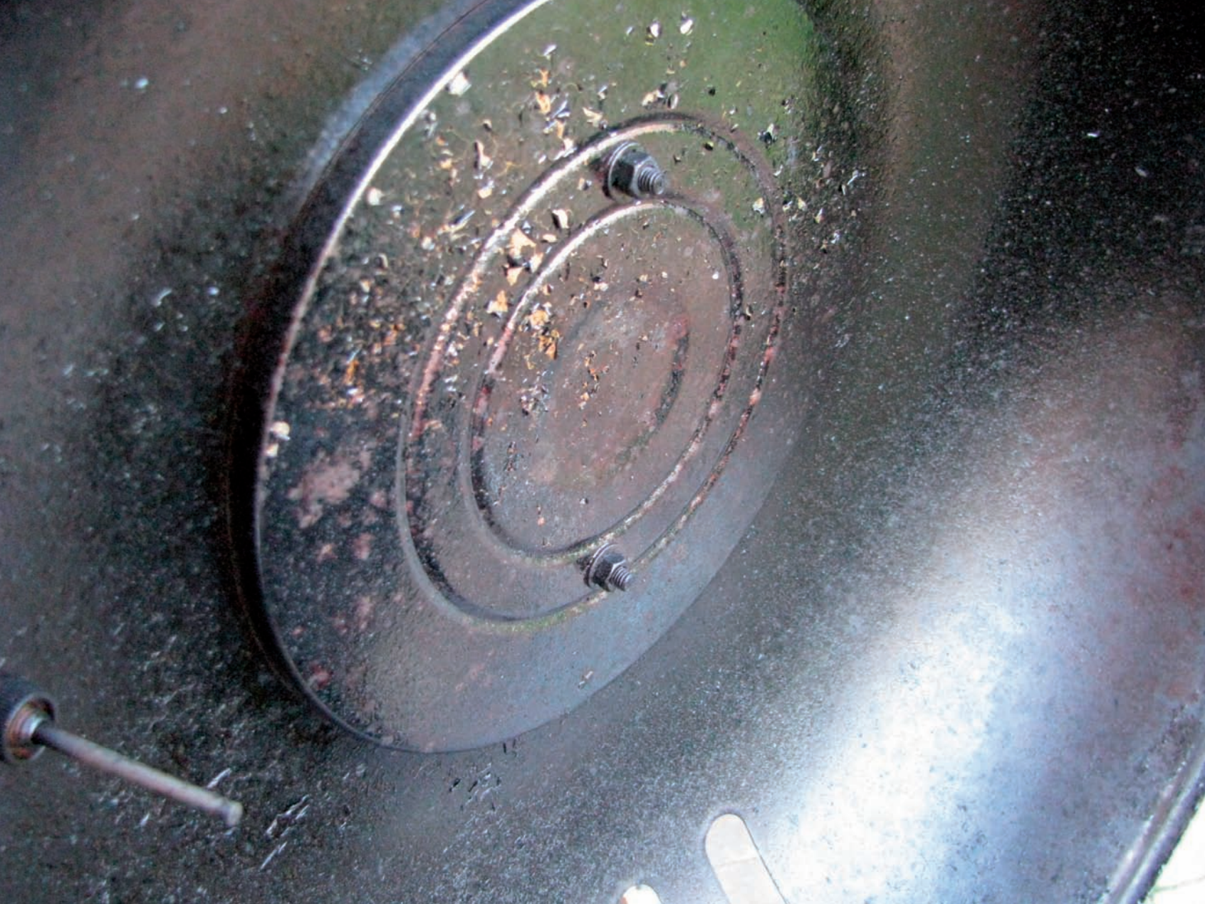
Patinabildung im Deckel eines Gasgrills; im Vordergrund sieht man den Fühler des Deckelthermometers.
