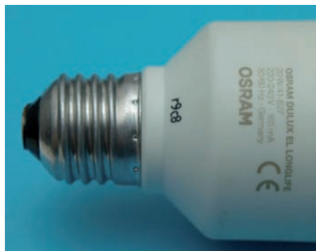
Osram-Energiesparlampe. Kennzahl 827, also 80 % des Spektrums bei 2.700 Kelvin Farbtemperatur.
