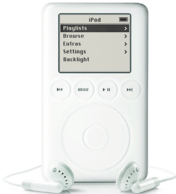
Abbildung 2003.9 Zusammen mit iTunes 4 und dem Music Store führte Apple den iPod 3G ein. Er war mit einer 10-, 15- und 30-Gbyte-Festplatte erhältlich und hatte erstmals ein TouchWheel ohne bewegliche Teile. (Bild: Apple)
