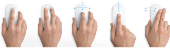
Abbildung 08/09.29 Die Magic Mouse ließ sich per Multitouch-Oberfläche über Gesten steuern. (Bild: Apple)
