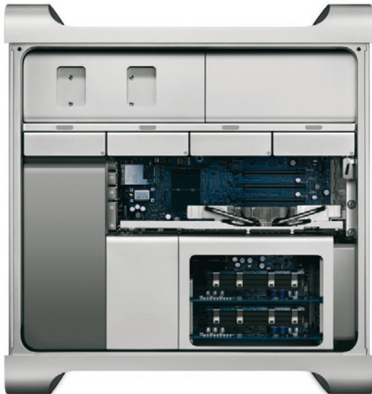
Abbildung 2006.19 Im neuen Mac Pro arbeiteten die neuen Quad-64-Bit-Xeon-Prozessoren von Intel. (Bild: Apple)
