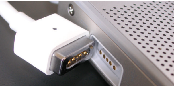
Abbildung 2006.18 Auch das MacBook wurde mit dem neuartigen zugsensiblen, magnetisch haltenden Stromstecker MagSafe ausgestattet. (Bild: Wikimedia)
