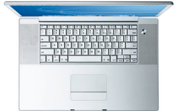
Abbildung 2003.4 Das PowerBook Pro 17" hatte erstmals eine Tastaturbeleuchtung, die sich den äußeren Lichtverhältnissen anpasste. (Bild: Apple)
