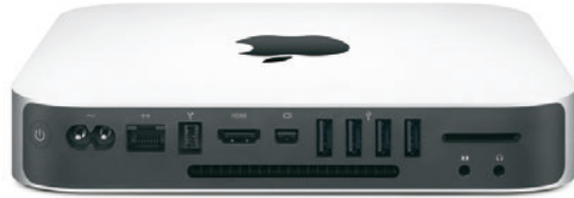
Abbildung 08/09.27 Über einen HDMI-Anschluss war der Mac mini ab 2010 auch fähig, Full-HD-Displays und -Fernseher mit Bild und Mehrkanalton zu beliefern. (Bild: Apple)
