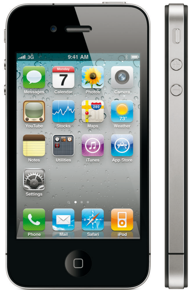
Abbildung 2010.3 Apple bezeichnete das iPhone 4 mit seinen 9,3 Millimetern als das dünnste Smartphone aller Zeiten. (Bild: Apple)
