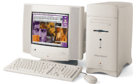
Abbildung 1996.3 Nicht nur das PowerBook 5300 machte Apple 1996 schwer zu schaffen, auch der Performa 6400 konnte entweder nur drucken oder nur das Modem nutzen, da er bloß eine serielle Schnittstelle besaß. (Foto: Apple)
