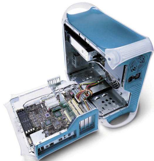
Abbildung 1999.1 Dank eines speziellen Ausklappmechanismus des Motherboards ließ sich der PowerMac G3 leicht mit bis zu drei Festplatten und mehr RAM ausstatten. (Bild: Apple)
