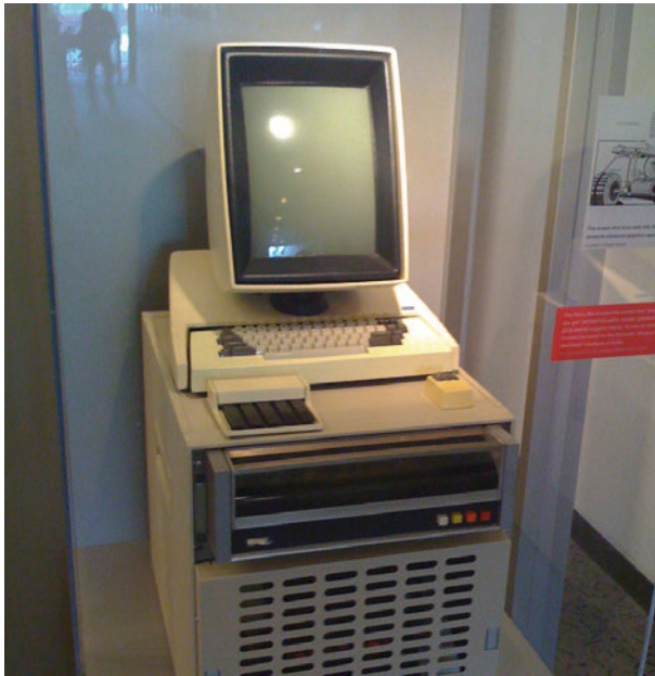
Abbildung 78/79.4 Der Xerox Alto war der erste Computer mit grafischer Benutzeroberfläche und Mausbedienung. (Bild: Wikimedia, Saschapohflepp)
