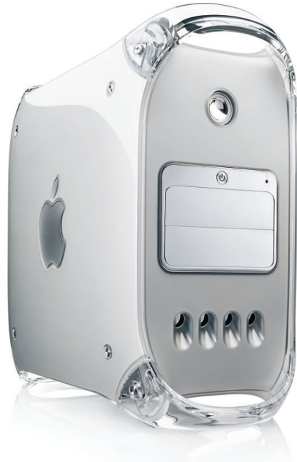
Abbildung 2002.18 Der 2002 vorgestellte PowerMac G4 mit seinen „Mirrored Drive Doors“ hatte vorne an Auspuffrohre erinnernde Öffnungen, über die fünf eingebaute Lüfter ihre Abwärme abgaben – und entsprechend Lärm veranstalteten. (Bild: Apple)
