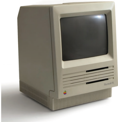
Abbildung 1987.1 Der Macintosh SE – „System Expansion“ – war endlich erweiterbar. (Bild: Wikimedia, Danamania)
