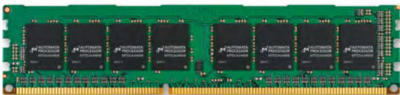
Sieht aus wie normaler DDR3-Speicher, trägt aber jede Menge Processing Power in sich: Microns Automata-Prozessor.
