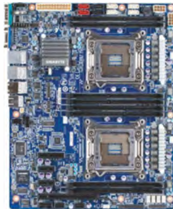
Auf dem GA-7PXS1 schafft Gigabyte Platz für zwei LGA-2011-Kühler normaler Größe.
