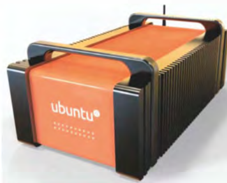
Die Orange Box von Canonical packt einen kompletten Cluster in 32 Kilogramm.
