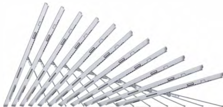
Der integrierte Ständer des Surface Pro 3 erlaubt deutlich flachere Aufstellwinkel als der Vorgänger.
