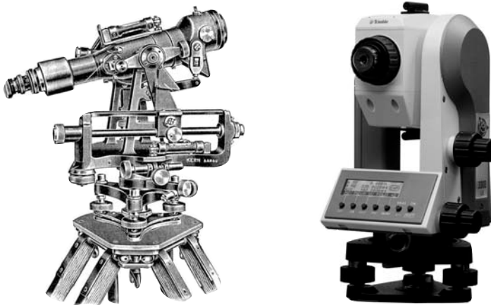
Abb. 3.3.3: Tachymeter von 1926 (Kern, Aarau/Schweiz) und elektronischer Tachymeter Trimble 3300 DR (Trimble GmbH, Raunheim)
