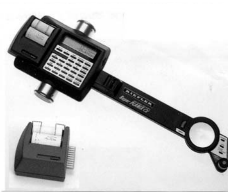
Abb. 9.3.7: Planimeter zur Flächen- und Streckenbestimmung mit Drucker und Interfaceschnittstelle (Riefler GmbH, Nesselwang)
