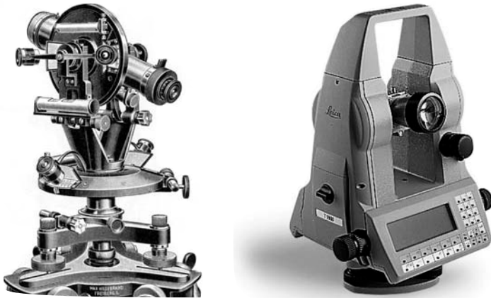
Abb. 3.2.3: Theodolit aus dem Jahre 1930 (Hildebrand, Freiberg) und elektronischer Theodolit Leica T 1000 (Leica Geosystems AG, Heerbrugg/Schweiz)
