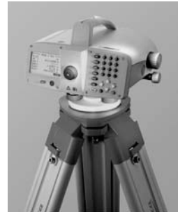
Abb. 3.2.5: Prinzip der Höhenmessung durch Nivellement (nach Hake 1982) und Digital-Nivellier Leica DNA (Leica Geosystems, Heerbrugg/Schweiz)
