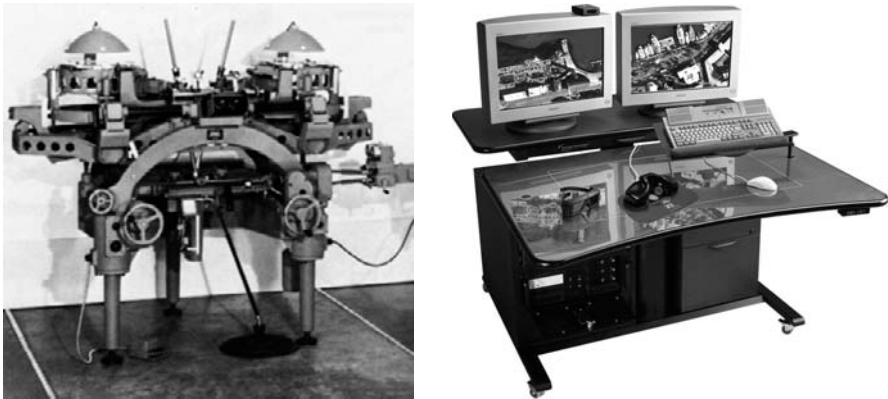
Abb. 3.4.8: Analogauswertgerät Stereoautograph A8 von Wild aus dem Jahre 1950 (ohne Kartiertisch) und digitale photogrammetrische Arbeitsstation ‚Image Station‘ (Intergraph Z/I, Aalen)
