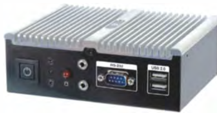
Kleine Kiste mit vier Kernen: Im ulBX-230-BT steckt ein Atom-Prozessor aus Intels Bay-Trail-Familie.
