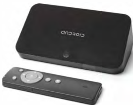
Im Gehäuse des BL-A9 von Beelink steckt vor allem viel Luft. Die Sendeleistung der IR-Fernbedienung ist etwas zu schwach ausgelegt.
