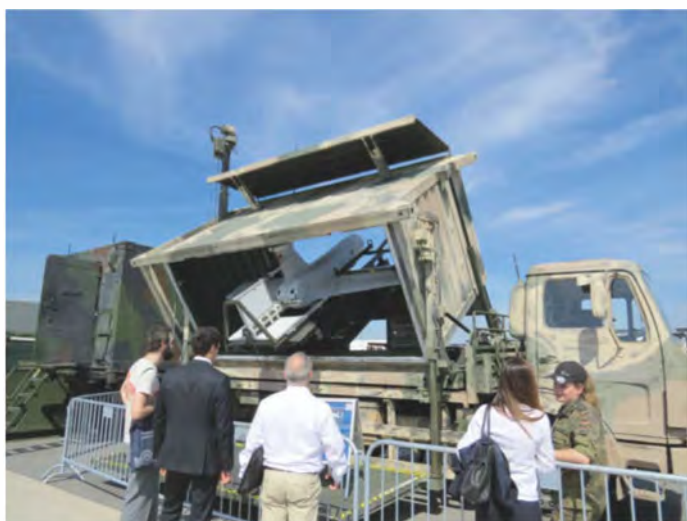
Das bis zu 180 km/h schnelle „Kleinfluggerät Zielortung“ (KZO) mit Infrarotsensor dient der Bundeswehr als unbemannte Drohne zur „Lage- und Wirkungsaufklärung von bewegten und stehenden Zielen“. Die Flughöhe des KZO beträgt maximal 4000 Meter, die Flugdauer fünf Stunden.
