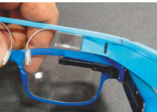
Das White-Pupil-Modul im Brillenprototyp des Mikrodisplay-Spezialisten Kopin ist deutlich kompakter als die Brillenoptik von Google Glass (oben).
