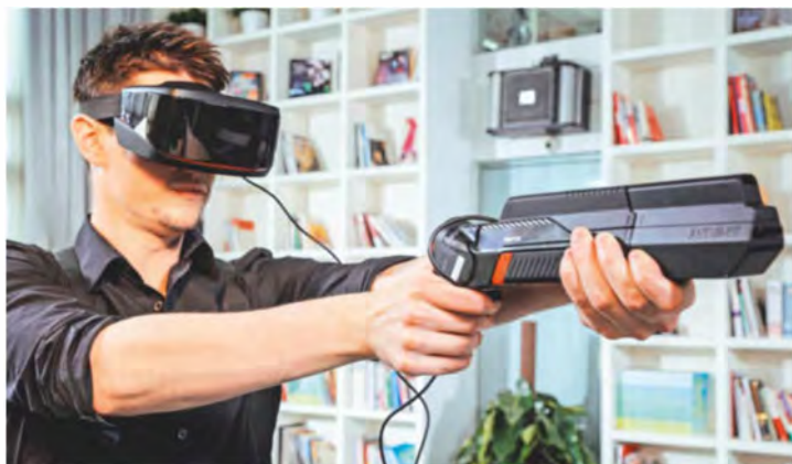
Die AntVR-Brille wird mit einem extrem wandelbaren Controller geliefert: Er lässt sich als Gamepad, Lichtschwert, Lightgun oder Lenkrad nutzen.
