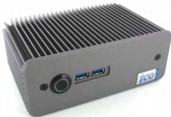
Aus Intels NUC mit einem Ultrabook-Prozessor baut ICO den lüfterlosen Haswell-PC PicoSYS 2693.
