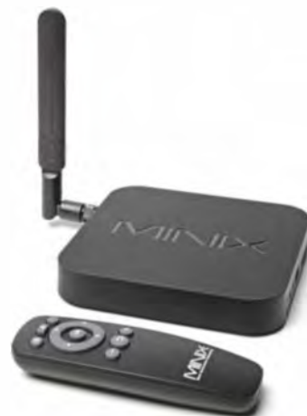
Minix' Neo X7 kommt als Apple TV mit Überbreite. Die kleine IR-Fernbedienung sorgt mit zwei Infrarotsendern für eine sichere Bedienbarkeit.
