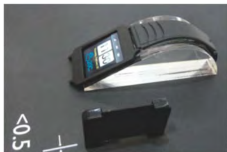
Die Smartwatch mit dem 1,6-zölligen OLED von AUO nutzt den sogenannten In-Cell-Touch, der zehn Berührungspunkte erkennt und kaum aufträgt.
