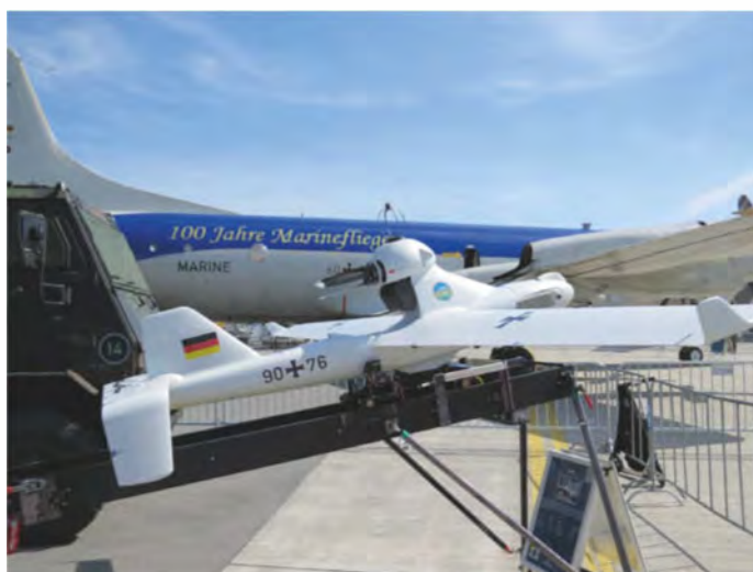
Die „Luftgestützte unbemannte Nahaufklärungs-Ausstattung“ (Luna) liefert programm- beziehungsweise ferngesteuert Video- und Infrarotfilme vom Einsatzgebiet. 84 Maschinen befinden sich im Bestand, 56 sind BW-Angaben zufolge schon verloren gegangen.
