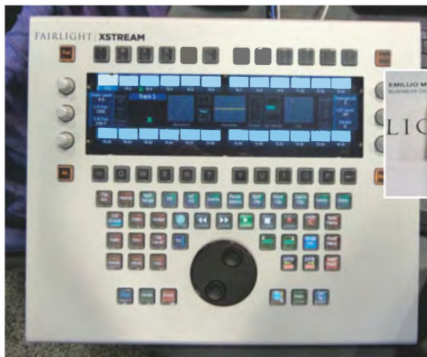
Im Audio-Controller von Fairlight heben Polymerfaserbündel der Firma Incom kleine Bildausschnitte des LCD von der Grundplatte auf die Taster.
