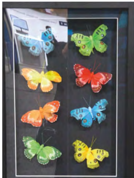
Rechts mit Entspiegelung, links ohne – die Firma Sapphir rüstet auch Museen mit ihren beschichteten Gläsern aus.
