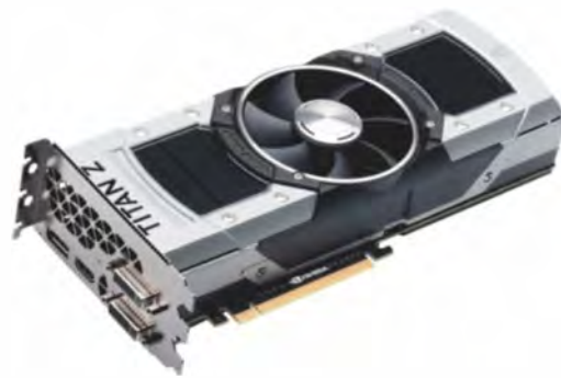
Die GeForce GTX Titan Z ist Nvidias stärkste Grafikkarte – den beiden GK110-Grafikchips sei Dank.
