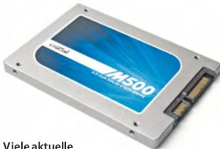
Viele aktuelle SSDs unterstützen die Devsleap-Funktion, die aber nur in besonderen Systemen spürbaren Nutzen bringt.
