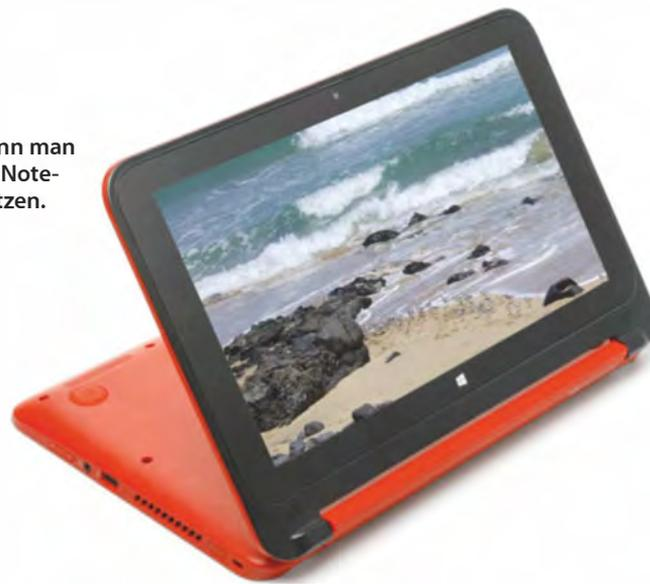
Buchsen spricht USB 3.0, externe Monitore werden per HDMI angesprochen. Zudem gibt es einen Kartenleser, der schnelle SDXC-Karten mit voller Geschwindigkeit anspricht, und eine LAN-Buchse. Der WLAN-Adapter funkt ausschließlich im 2,4-GHz-Band, Bluetooth ist ebenfalls an Bord.
