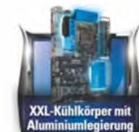
Der extragroße Kühlkörper führt die Hitze ab und kühlt MOSFETs und Chipsätze
