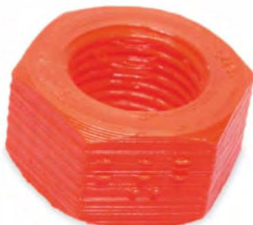
Außen top, für ein brauchbares Innengewinde muss man allerdings die Druckparameter feintunen.
