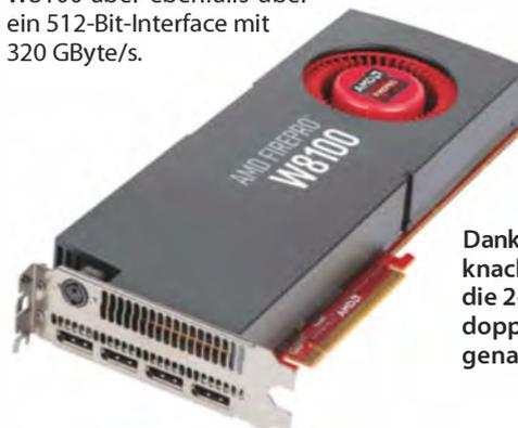
Dank 2560 Rechenkernen knackt die FirePro W8100 die 2-TFlops-Marke bei doppelter Gleitkomma-Genauigkeit.
