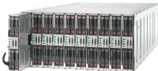
**HP Apollo 6000: 20 Xeon-E3-Maschinen in 5 Rack-Höhen-einheiten**
