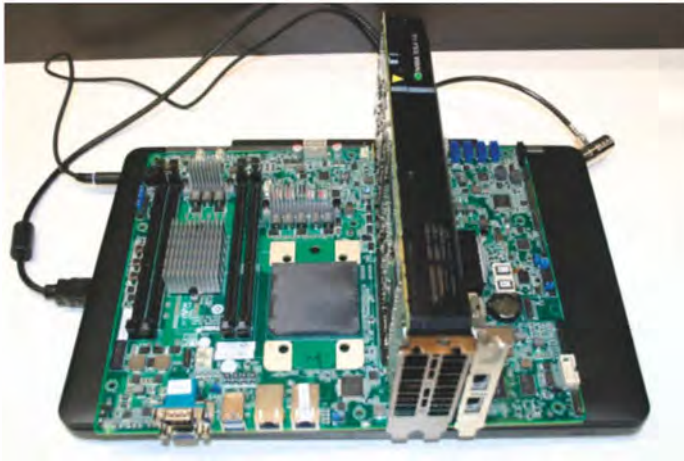
OpenPower: Tyan-Board mit Nvidia Tesla K40, leider noch ohne Power8-Prozessor
