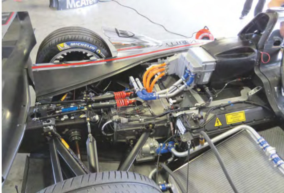
Das Herz eines Formula-E-Rennwagens. Rechts oben (grauer Kasten) ist die Motor Control Unit (MCU) von McLaren zu erkennen, darunter sitzt die mächtige Batterie. Im silbernen Teil (Bildmitte) befinden sich Getriebe und Elektromotor.
