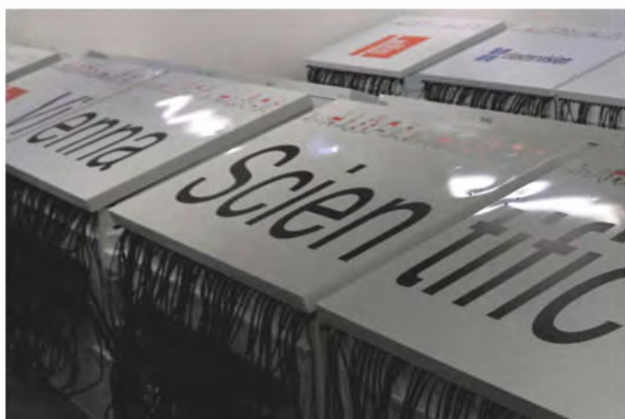
Nach Ötzi jetzt Öli – Österreichs Öl-Rechner VSC-3, hier ein Blick auf die gefüllten CarnotJet-Container.
