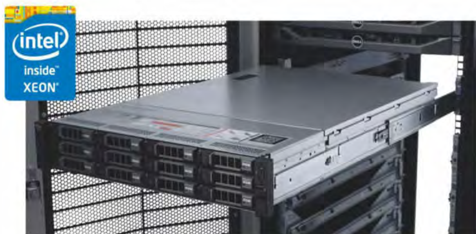
Der Rock-Server Dell PowerEdge R720 unterstützt bis zu zwei NVIDIA-GRID-K1- oder -K2-Grafikkarten. (Quelle: Dell)
