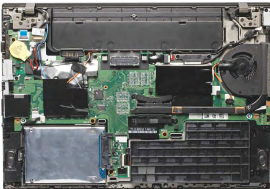
Lenovo baut in manche Konfigurationen der ThinkPads T440 und T440s Zweitakkus ein. In unseren Testgeräten füllt ein stabilisierender Plastikeinsatz (unten rechts) den Platz.
