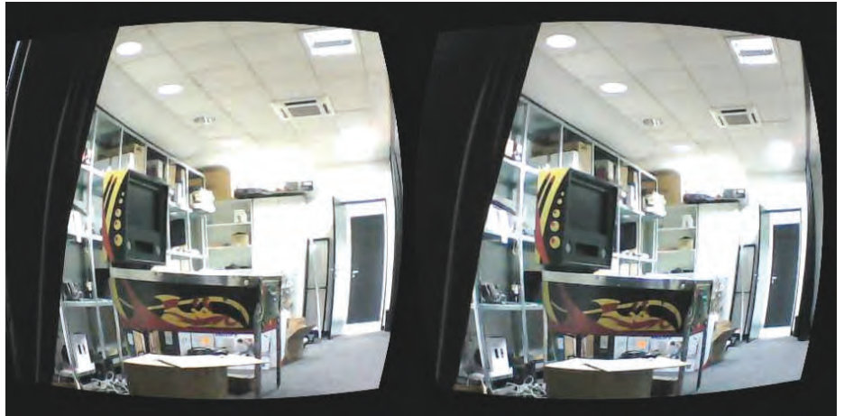
Die für die Oculus-Rift-Brille erforderliche Verzerrung der Kamerabilder übernimmt OpenCV.
