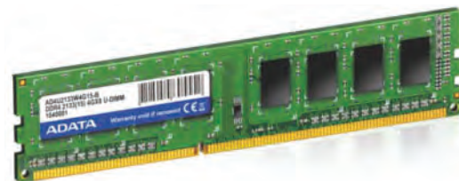
DDR4-DIMMs haben 288 Kontakte und damit 48 mehr als solche mit DDR3-Speicher.
