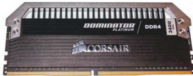
Ein DDR4-DIMM sieht nicht viel anders aus als ein DDR3-Riegel, aber der Kontaktkamm hat einen leichten Schwung.
