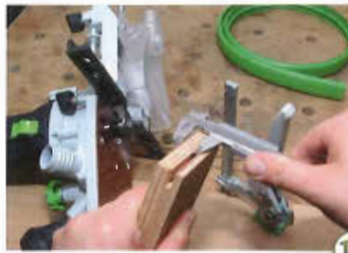
14 > Der Scheibennutfräser muss ausgerichtet werden. Die Frästiefe kann an einem Probestück eingestellt werden. Es genügt, sich am Abstand von der Oberseite zu orientieren.
