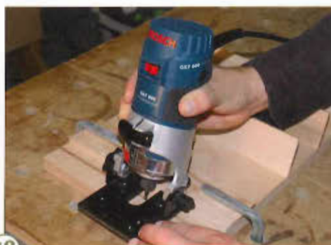
18 > An einem Anschlag entlang geführt lassen sich so schräge Nuten einfräsen.
