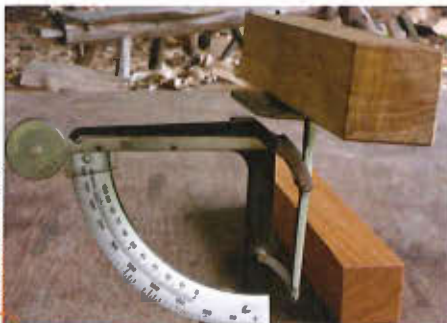
Zwei gleichgroße Kanten aus Eichenholz werden gewogen – die grobjährige bringt 490 Gramm auf die Waage, ...
