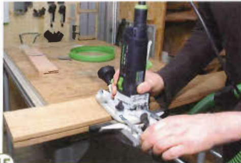
15 > Die Frästiefe begrenzt das Anlaufkugellager. Alternativ kann diese über den Parallelschlag verringert werden.
