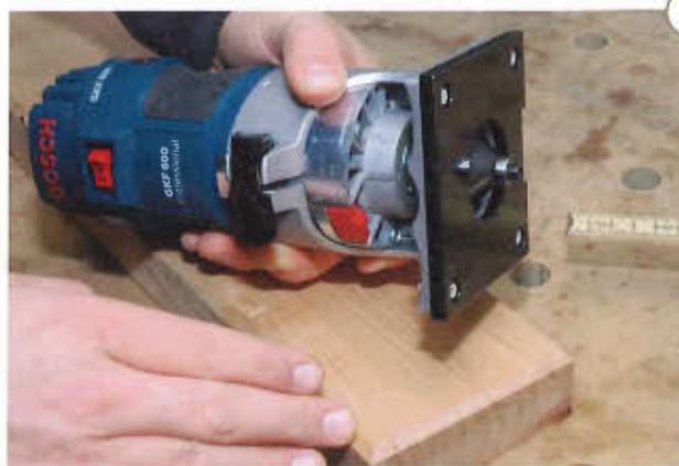
2 > Kontrollieren Sie die Einstellung immer erst an einem Probeholz.
