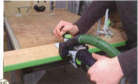
16 > Der Überstand an Ober- und Unterseite kann wie bei anderen Anleimern bündig gefräst werden.
