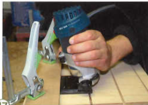
17 > Über eine verstellbare Grundplatte wird der Winkel bestimmt.
