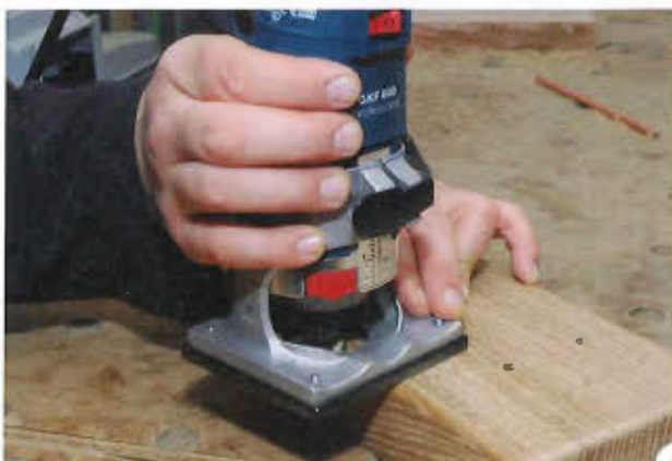
4 > Jetzt kann es am Werkstück losgehen. Die Kanten sollten direkt vor dem letzten Schliff in die unbehandelte Massivholz-oberfläche gefräst werden. Gerade in fein geschliffenes Holz geraten sehr schnell Kratzer durch eine Kantenfräse.
