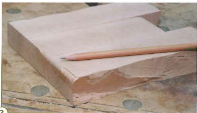
3 > Kanten runden: Stellt man den Fräser zu tief ein, sieht oder spürt man einen Versatz (Vordergrund). Dieser kann natürlich auch als Polster für spätere Schleifarbeiten oder als gestalterisches Element erwünscht sein. In kleinen Schritten wird die Frästiefe bis zum voll ausgeformten Viertelkreis verringert.
