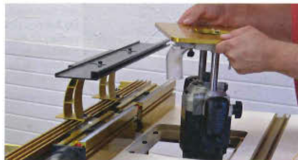
Einlegeplatten für Frästische: So werden sie montiert
