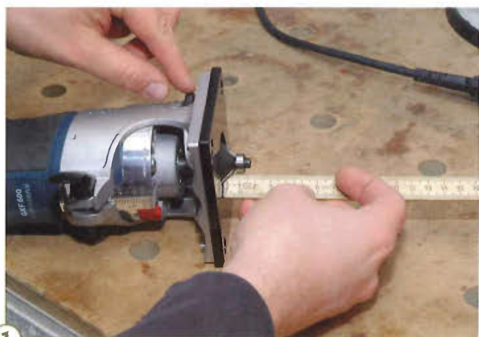
1 > Kanten fassen: Beim Einstellen der Frästiefe können Messwerkzeuge einen guten ersten Anhaltspunkt geben. Dort wo Fräser und Skala sich treffen, kann man die Größe der Fase ablesen.
