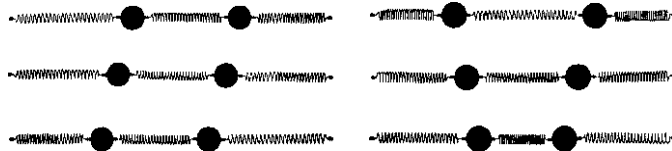
Abb. 272. Je drei Momentbilder von Longitudinalschwingungen zweier gekoppelter Federpendel. Oben und unten im Zeitpunkt großer Ausschläge, in der Mitte beim Passieren der Ruhelage. — Links schwingen beide Körper mit gleicher Phase, rechts hingegen um 180° gegeneinander phasenverschoben.
