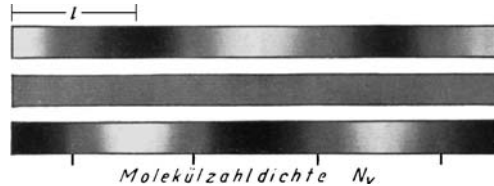
Abb. 279. Drei Momentbilder für die Verteilung der Anzahldichte N_v in einer geschlossenen Gassäule, die mit ihrer vierten Eigenfrequenz schwingt. Oben und unten in Zeitpunkten der größten Amplituden der Dichteänderung, in der Mitte gleichmäßige Dichteverteilung in dem zwischen beiden liegenden Zeitpunkt. Die Längenabschnitte l des oberen und des unteren Teilbildes entsprechen den Teilbildern b und a der Abb. 274, also einer halben Wellenlänge. K12
