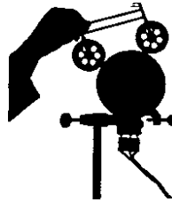
Abb. 122. Ein Fahrradmodell wird durch Anpressen an eine Scheibe auf der Achse eines Elektromotors in Gang gesetzt ( Videofilm 25 )
