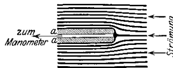
Abb. 220. Ein Pitotrohr zur Messung des Gesamtdruckes in einem Staugebiet. In natura ein rechtwinklig gebogenes Rohr von meist nur 2 bis 3 mm äußerem Durchmesser (Modellversuch mit dem Stromfädenapparat (Abb. 210), Konturen des Rohres nachträglich schraffiert)
