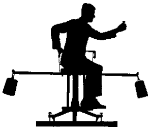
Abb. 143. Ein Drehstuhl mit großem Trägheitsmoment zur Vorführung von Corioliskräften. Die seitlich angehängten Klötze großer Masse benutzt man zweckmäßig auch bei den in den Abb. 134, 138, 140 und 142 dargestellten Versuchen. K8
