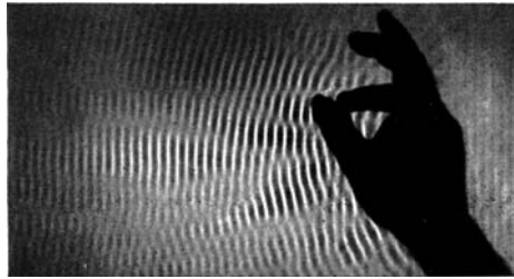
Abb. 356. Das Schallabdruckverfahren macht das Interferenzfeld hochfrequenter Schallwellen vor einer ihre Gestalt ändernden Hand sichtbar (Momentaufnahme, d. h. Hand während der Aufnahme in Ruhe)
