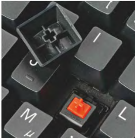
In fast allen hochwertigen Tastaturen stecken mechanische Schalter von Cherry – hier vom Typ MX Red.
