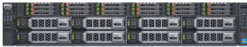
Dell kombiniert beim PowerEdge R730xd acht 3,5-Zoll-Festplatten mit 18 SSDs im 1,8-Zoll-Format.
