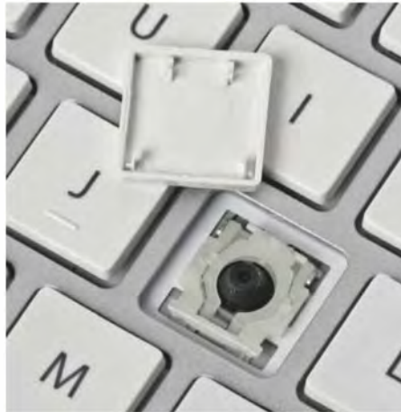
Die meisten Notebook- und einige Desktop-Tastaturen nutzen Scherentechnik. Sie bietet einen härteren Anschlag und hält etwas länger.
