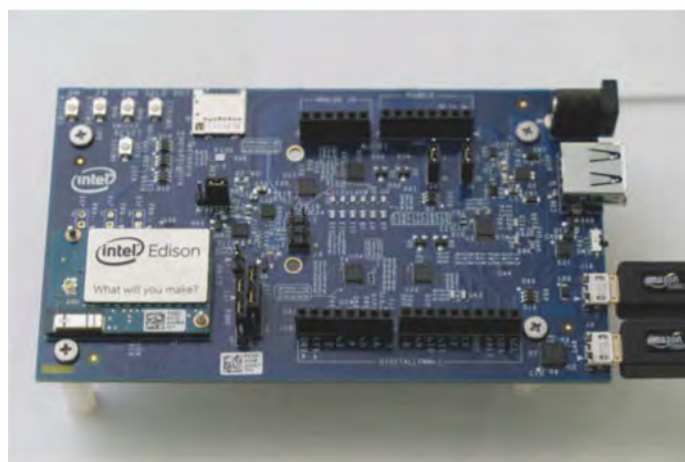
Intels Edison ist an sich nur das kleine Modul links unten, welche hier auf einer ungleichgrößeren Erweiterungsplatine mit vielen I/O-Ports steckt.
