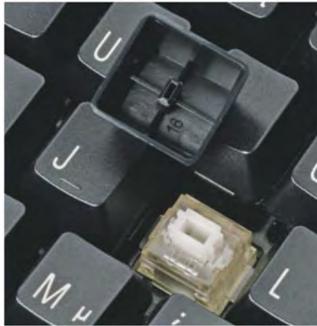
In den Tastaturen des Herstellers Matias steckt ein Abkömmling der besonders im Mac-Sektor lange benutzten Alps-Schalter.
