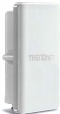
Der Outdoor-Access-Point TEW-738APBO von Trendnet soll Punkt-zu-Punkt-WLAN-Verbindungen aufbauen.
