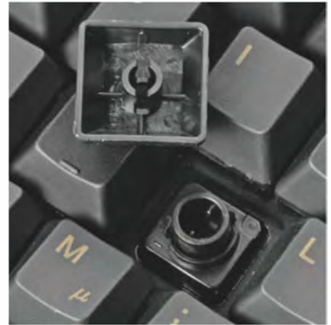
Die Schalter des japanischen Herstellers Topre kombinieren Gummikuppeln mit konischen Federn.
