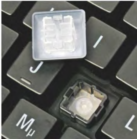
Bei Membrantastaturen sorgen Gummikuppeln für einen weichen Druckpunkt. Sie verschleissen allerdings schnell.
