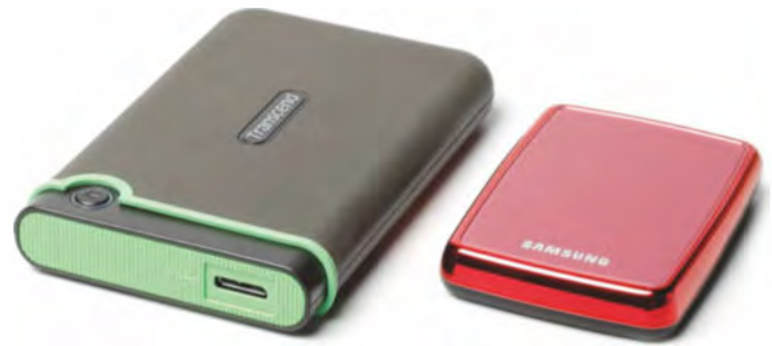
Externe Mini-Festplatten wie die kleine Samsung 1,8"-HDD (rechts) sind leider ausgestorben. Externe Speicher mit 2,5"-HDD gibt es dagegen en masse. Die Transcend StoreJet soll besonders schockresistent sein.
