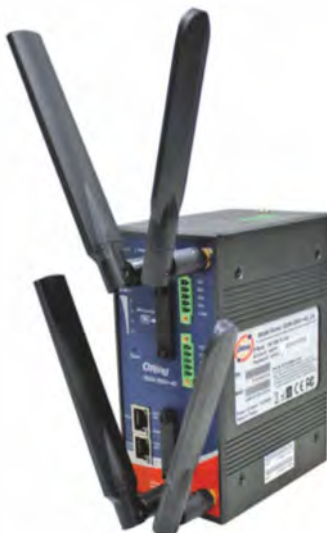
Der Router IGAR-2062+4G von ORing soll abgelegene Industrieanlagen per LTE-Mobilfunk und VPN ins Firmennetz einbinden.
