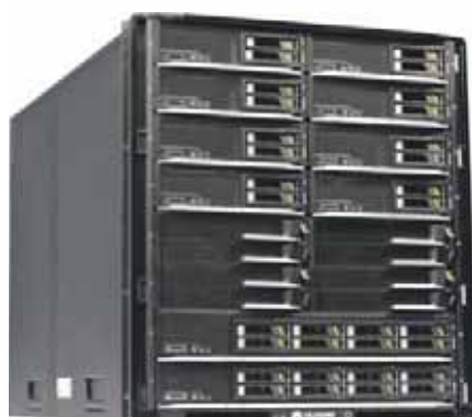
In den FusionCube von Huawei passen 16 Server-Blades
