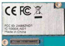
Edison in Originalgröße, Unterseite mit Hirose-Steckwanne
