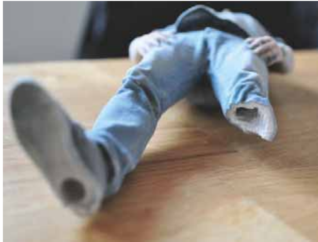
Große Gipsfiguren – meist ab 20 cm Höhe – werden von vielen Anbietern hohl ausgedruckt, um teures Material zu sparen.
