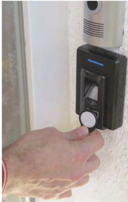
Der Homematic-Türöffner ist auf der Innenseite der Eingangstür platziert. Im Außenbereich hängt ein Öffner, welcher sich per Funkfernbedienung, Transponder-Chip oder Fingerabdruck steuern lässt.
