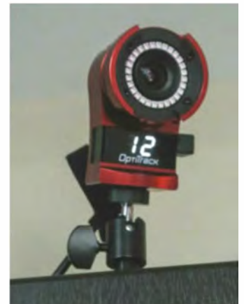
16 Mocap-Kameras vom Typ Optitrack Flex 13 hat Teitler für seine Jedi-Cave an den Wänden verteilt.
