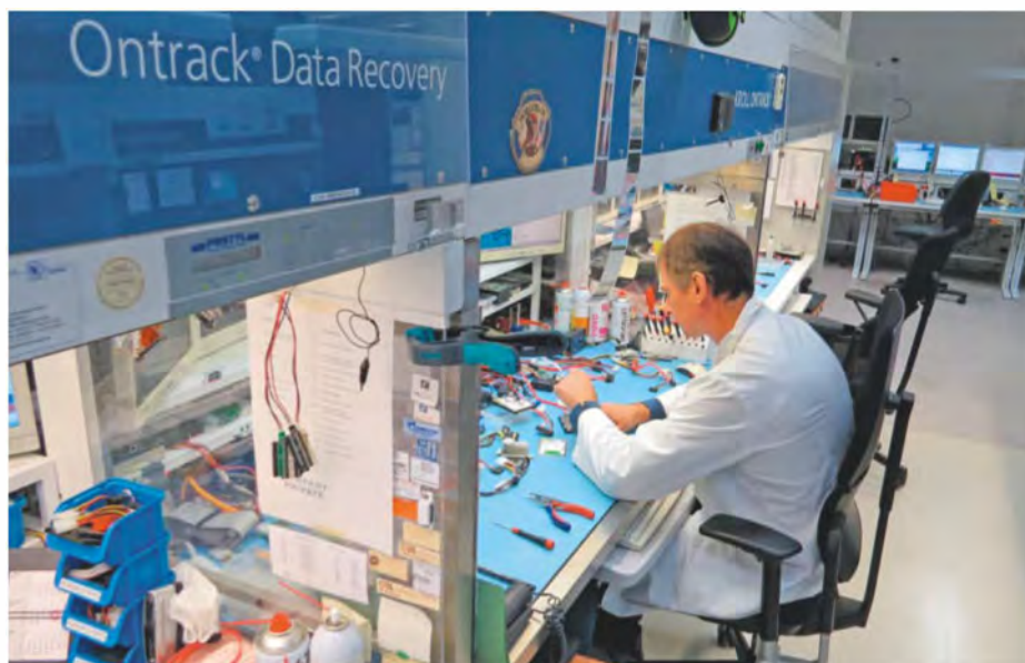
An sechs Arbeitsboxen mit speziellen Abzügen werden Festplatten repariert, um sie ein letztes Mal auszulesen. In dem nach ISO 14644-1 Klasse 5 zertifizierten Reinraum dürfen sich pro Kubikmeter Raumluft maximal 100 000 Partikel größer ein Mikrometer befinden.
