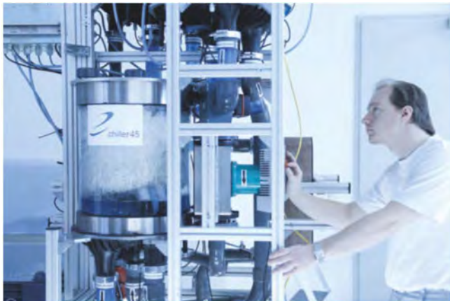
Kältemaschine mit Wasser als Kältemittel: eChiller 45
