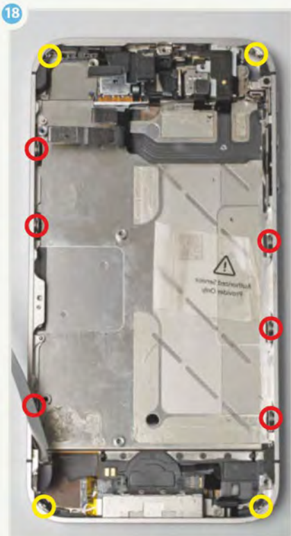
Gelb markierte Schrauben entfernen, rot markierte um eine Umdrehung lockern.
