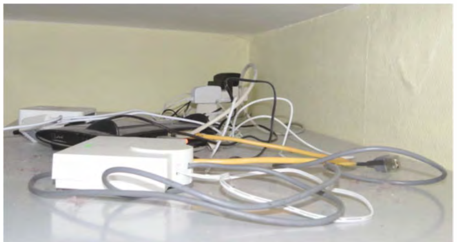
Die Schaltzentrale der Macht – eine FritzBox und die Homematic CCU-2 – liegt in 2,3 Meter Höhe „unsichtbar“ auf dem Schrank.
