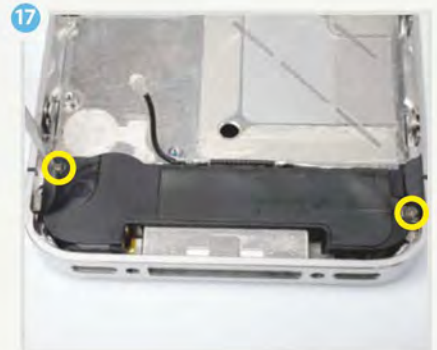
Zwei Schrauben lösen, Lautsprecher samt dem kleinen Plastikdreieck herausheben.
