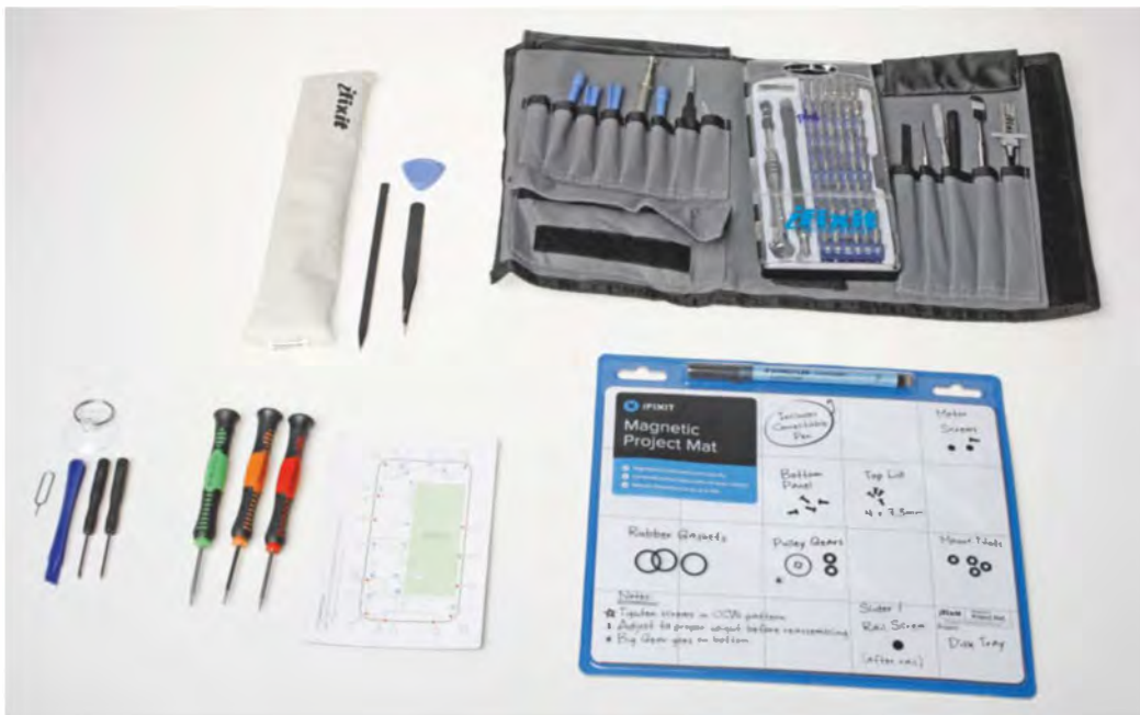
Vielen Ersatzteilen liegt billiges Werkzeug bei: Plastikspatel und winzige Schraubendreher (ganz links). Die Fixxoo-Reparatursets enthalten gute Schraubendreher und die wichtige magnetische Unterlage für Schrauben. Fixxoo und iFixit verkaufen Werkzeugsets mit Dutzenden Teilen und magnetische Unterlagen zum Selbst-Beschriften.
