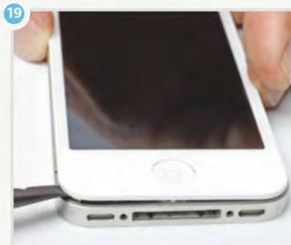
iPhone umdrehen, mit einem Plastikspatel das Display lockern, vorsichtig anheben, aber noch nicht entfernen.
