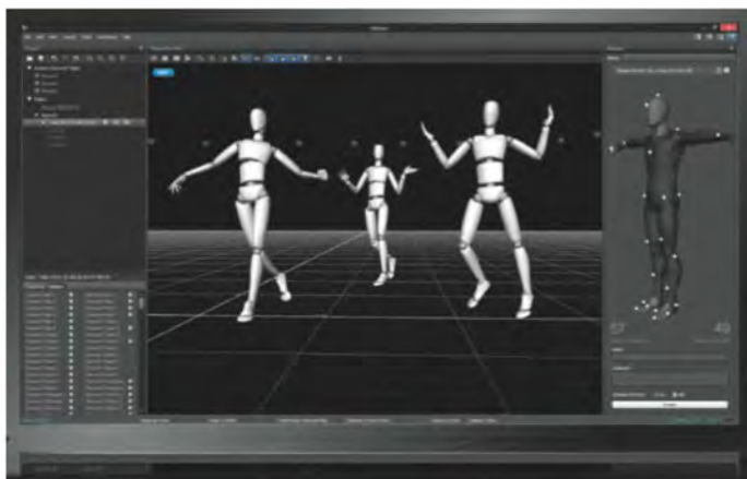
Die Motive-Software von Natural Point empfängt die synchronisierten Positionsdaten der Kameras und reicht sie an das Spiel weiter.
