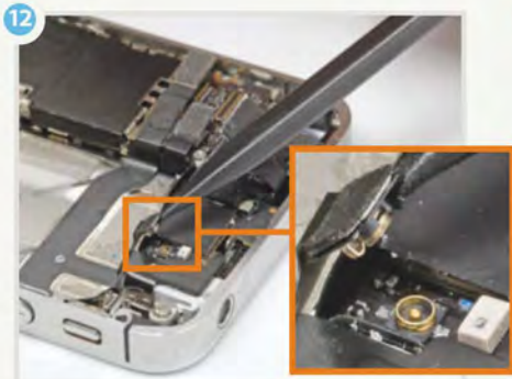
Den Stecker der WLAN-Antenne lösen.
