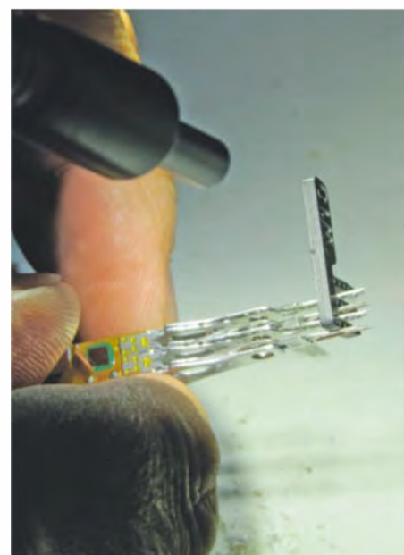
Sichtprüfung unter dem Mikroskop. Eine Abstandsklammer verhindert das Zusammenkleben der Schreib-/Leseköpfe.
