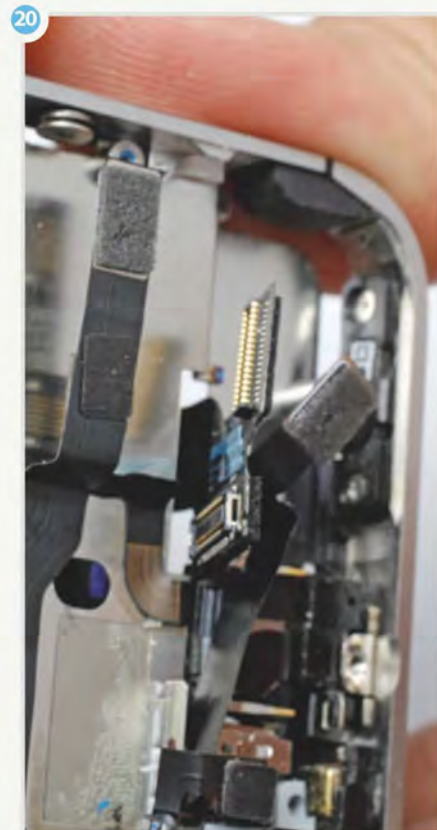
Zwei Schrauben lösen, Lautsprecher samt dem kleinen Plastikdreieck herausheben.
