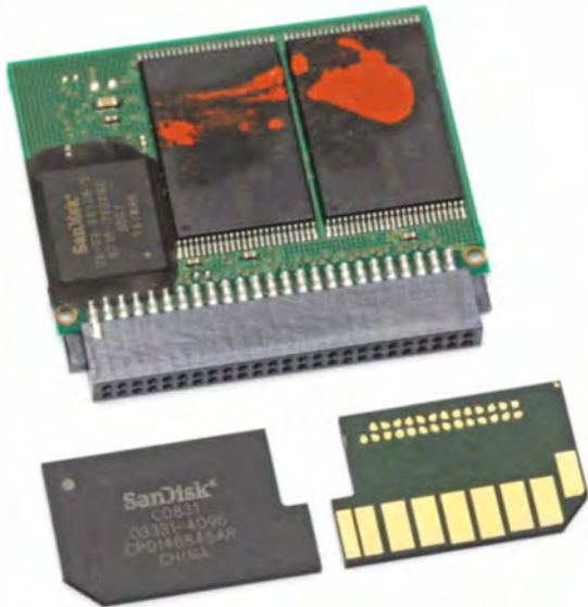
Bei CompactFlash-Karten lassen sich notfalls die Speicherchips austauschen, bei SD-Karten klappt das nicht – Flash und Controller sind in einem Baustein vereint.
