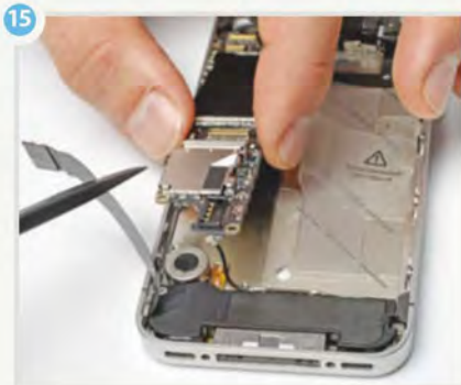
Mainboard unten anheben und langsam herausziehen.
