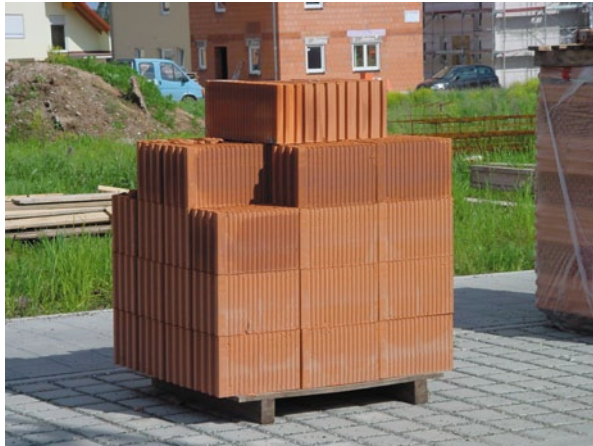
Abb. 3.9 Ohne Regenschutz aufgestapelte Porotonsteine saugen schnell viel Wasser
