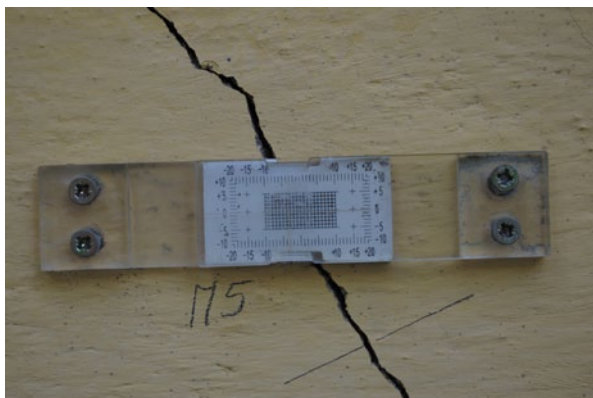
Abb. 6.12 Mit einem Setzdehnungsmesser lassen sich die Bewegungen der Rissflanken genau messen
