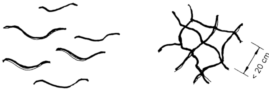
Abb. 10.28 Sackrisse ( links ), Schrumpfrisse ( rechts )
