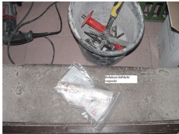
Abb. 6.26 Bohrkern luftdicht verpackt
