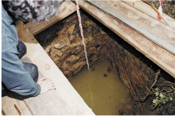
Abb. 5.2 Anstehendes Grundwasser wird in der Sondage gemessen und überprüft
