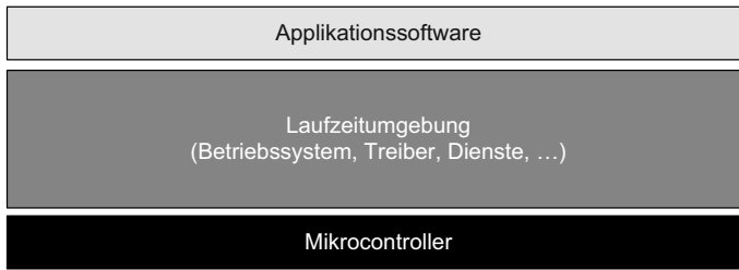
Abb. 3.2 Dargestellt ist der typische Aufbau einer Software-Architektur eines Steuergeräts
