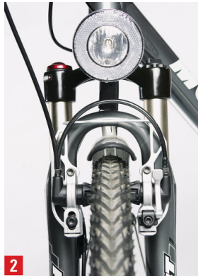
BILD 1: Ergonomische Griffe verhindern Ermüdungserscheinungen. BILD 2: Hydraulische Felgenbremse (Magura) BILD 3: Sehr beliebt: Nabenschaltung mit Rücktritt
