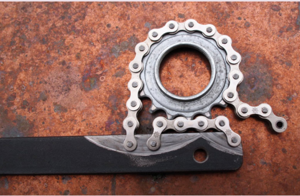
BILD LINKS: Zahnkranzabnehmer zum Abziehen der Ritzel am Hinterrad RECHTS: Abenteuerlich eingesetzte alte Notspeiche
