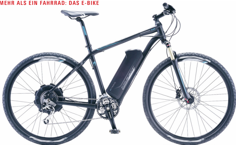
Sportliches E-Bike mit Hinterradantrieb und Akku am Rahmen
