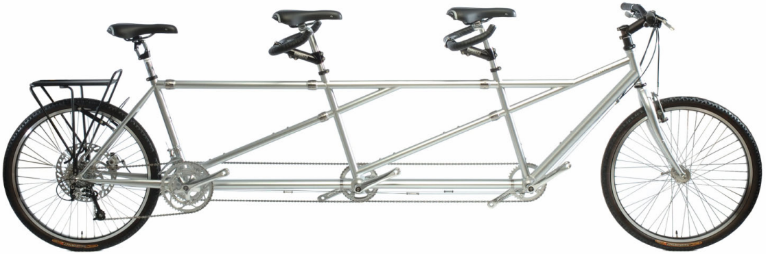
Auffälliger Dreier von Santana mit S&S-Kupplungen und gewaltigen Scheibenbremsen
