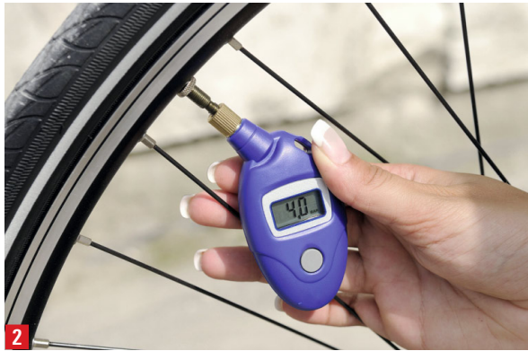
BILD 1 + 2: Der Reifendruck kann bei Luftpumpen mit Druckanzeige bereits während des Aufpumpens kontrolliert werden oder mit einem separaten Luftdruckprüfer.
