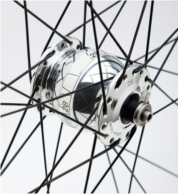
BILD LINKS: Der SON Nabendynamo eingespeicht RECHTS: Nabendynamo von Sram
