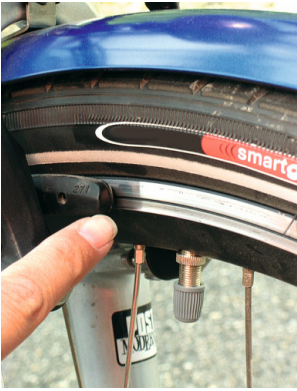
BILD LINKS: Verschleißmarkierung an der Felge MITTE: Läuft das Rad ohne Probleme? RECHTS: Der Bremszug wird gesäubert und geölt.
