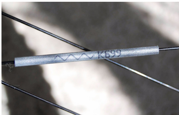
BILD LINKS: Bei Beleuchtungsteilen, wie in diesem Fall einem Speichenreflektor, immer auf die K-Nummer achten. RECHTS: Guter Seitenläuferdynamo
