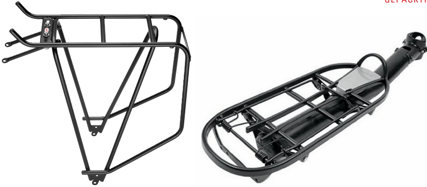
BILD LINKS: Stabiler Gepäckträger für viel Gepäck RECHTS: Der Rahmengepäckträger ist dagegen nur für wenig Last ausgelegt.
