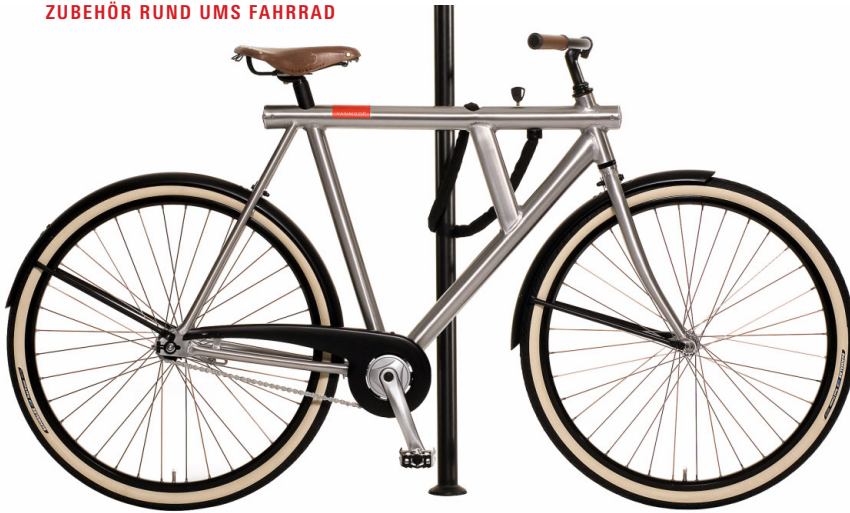
Besonders pfiffig: Das Schloss ist beim van-Moof-Rad in den Rahmen integriert.
