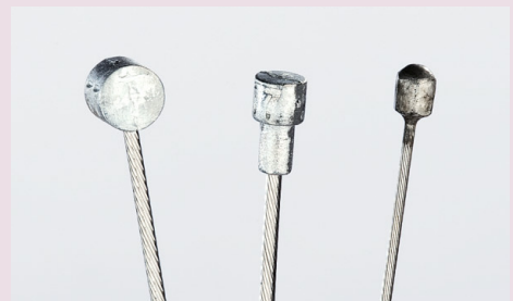
Links und Mitte: Bremszüge, rechts der deutlich kleinere Kopf eines Schaltzugs
