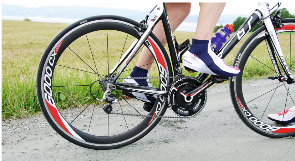
Klickpedale, bei denen Passstücke an den Schuhsohlen (Cleats) in flexible Klemmen an den Pedalen einrasten, erleichtern das Treten deutlich.
