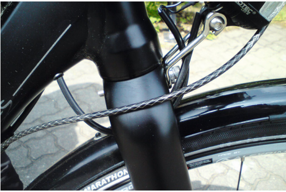
BILD LINKS: So nicht: Hier scheuern die Kabel. RECHTS: Gute Lösung: keine scheuernden Kabel bei Lenkbewegungen
