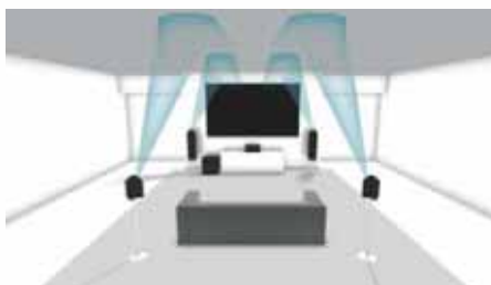
Atmos lässt sich mit Deckenlautsprechern realisieren (links) oder mit Boxen, die die Effekte Richtung Decke ausstrahlen (Mitte). Eine Option sind auch an der Wand, über Front- und Surroundboxen positionierte Höhenlautsprecher (rechts) – was bei Auro Standard ist.
