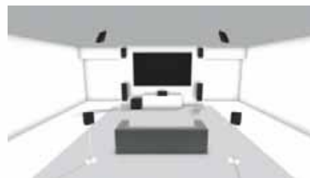
Atmos lässt sich mit Deckenlautsprechern realisieren (links) oder mit Boxen, die die Effekte Richtung Decke ausstrahlen (Mitte). Eine Option sind auch an der Wand, über Front- und Surroundboxen positionierte Höhenlautsprecher (rechts) – was bei Auro Standard ist.
