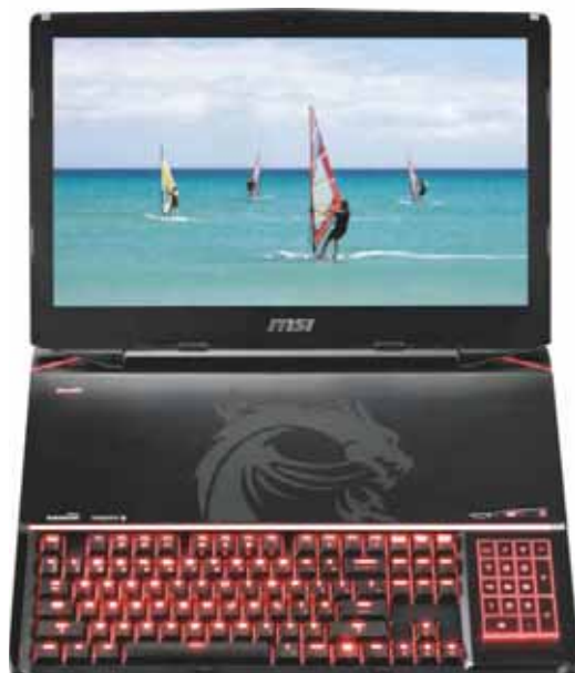
MSI baut in sein klobiges GT80 eine mechanische Tastatur mit braunen Cherry-MX-Schaltern ein.
