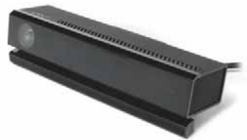
Die Kinect V 2 erkennt dank verbesserter Hardware auch die Position eines einzelnen Fingers und kann dadurch zum Klavierspielen in der Luft benutzt werden.
