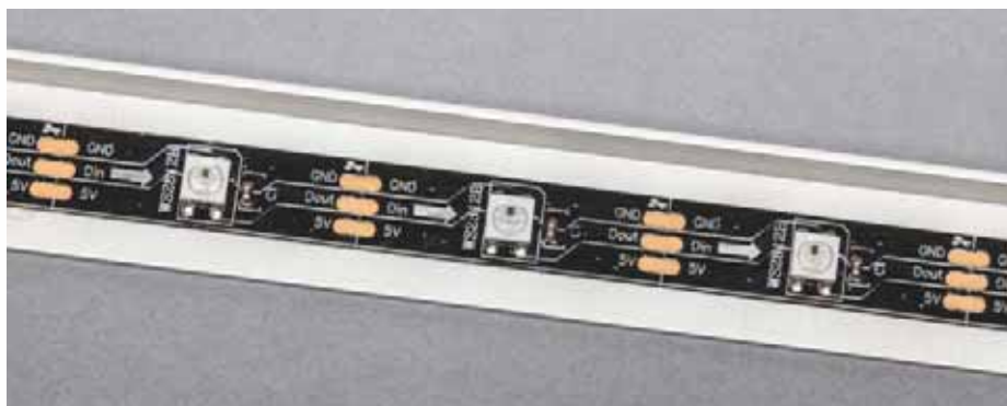
Der LED-Streifen mit WS2812B-Controller kann beliebig aufgetrennt werden.
