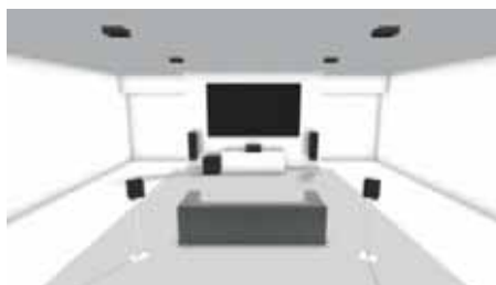
Atmos lässt sich mit Deckenlautsprechern realisieren (links) oder mit Boxen, die die Effekte Richtung Decke ausstrahlen (Mitte). Eine Option sind auch an der Wand, über Front- und Surroundboxen positionierte Höhenlautsprecher (rechts) – was bei Auro Standard ist.
