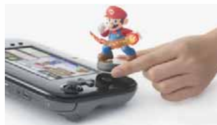
Das Gamepad der Wii U übernimmt bei den amiibo die Rolle des Portals – eine zusätzliche Hardware ist bei diesem System also nicht nötig, um die Eigenschaften der Figur auszulesen.
