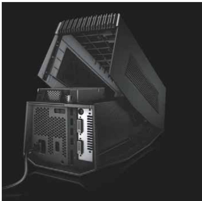
Die Grafikverstärker getaufte Zusatzbox des Alienware 13 nimmt Dual-Slot-Grafikkarten auf; ihr Netzteil liefert bis zu 375 Watt.
