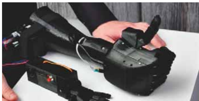
Die 3D-gedruckte Handprothese des Open Hand Projects gibt es für Kinder und Erwachsene.
