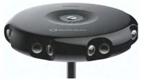
Die UFO-ähnliche 360-Grad-Kamera von Samsung besteht aus 16 Full-HD-Kameras.
