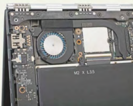
Core M mit Kühlsystem: Wenn letzteres nicht ausreicht, knickt die Performance ein.
