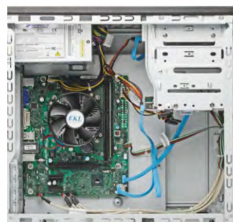
PCs mit 12-Volt-Technik arbeiten effizienter; Mainboard und Netzteil entsprechen aber nicht dem weit verbreiteten ATX-Standard.
