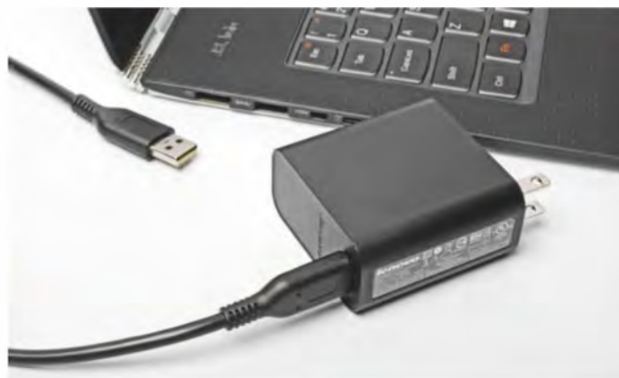
Das Yoga 3 Pro hat keinen dedizierten Stromanschluss mehr, sondern lädt über eine der drei USB-Buchsen. Das Steckernetzteil hat ebenfalls eine USB-Buchse und lädt darüber wahlweise auch Smartphone & Co.
