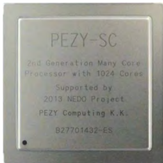
Der Pezy-SC, ein Coprozessor mit 1024 Kernen, war eine der großen Überraschungen auf der SC14.
