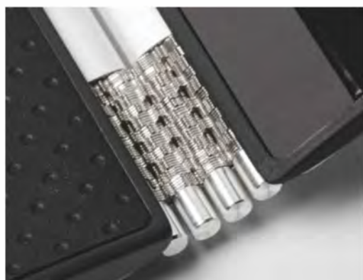
Feinmechanik: Jedes der insgesamt sechs Mehrfach-scharniere des Yoga 3 Pro besteht aus unzähligen filigranen Einzelteilen.
