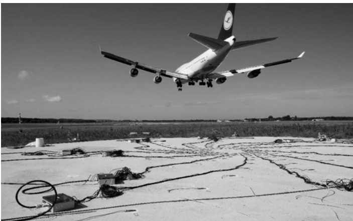
Abb. 6.33 Elliptisches Spiral-Array mit 238 Mikrofonen bei Überflugmessungen an einem Großraumflugzeug. 5
