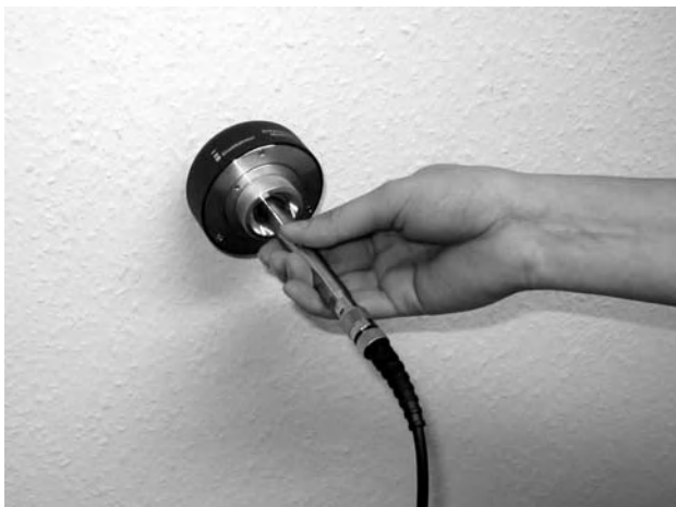
Abb. 4.16 Druckkammer im Einsatz (Bild: Stratenschulte)
