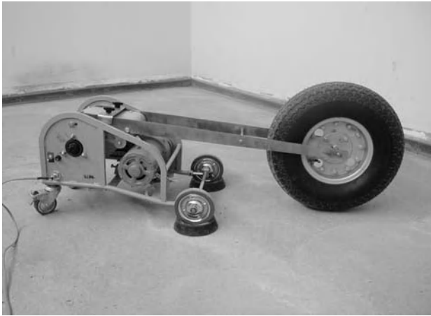
Abb. 4.38 Bang machine zur Trittschallmessung
