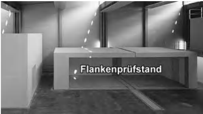
Abb. 4.19 Flankenprüfstand für horizontale Flankendämmung und Stoßstellendämmung (HFT-Stuttgart); Länge der im Bild offenen Prüföffnung ca. 11 m
