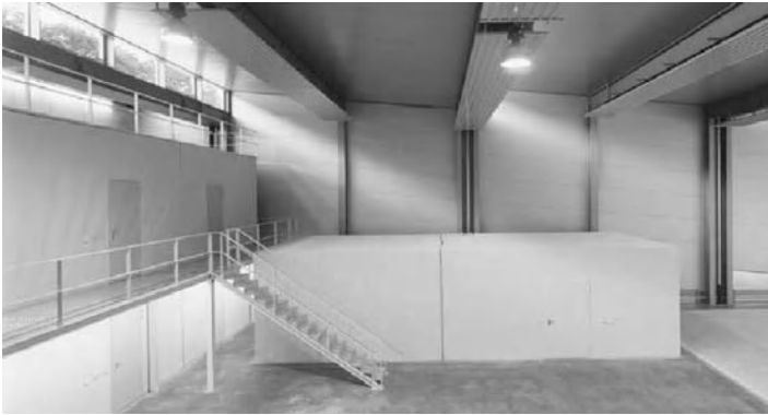
Abb. 4.17 Teilansicht eines bauakustischen Labors (HFT-Stuttgart) mit Wandprüfstand (mitte) und Deckenprüfständen (links)
