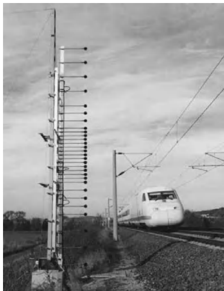
Abb. 6.30 Lineares Schachtel-Array für drei Oktaven. Vertikale Ausrichtung erlaubt die Lokalisierung vertikal verteilter Quellen. 2
