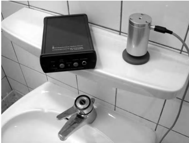
Abb. 4.39 Kleinhammerwerk bei der Körperschallanregung einer Konsole (Bild: Kurz+Fischer)
