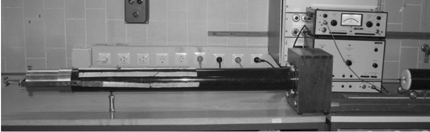
Abb. 10.1 Gesamtaufbau aus (von links) Objektträger, Rohr, Lautsprechergehäuse, Messsonde und Wagen
