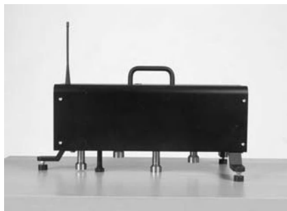
Abb. 4.32b Normhammerwerk mit geschlossenem Gehäuse (Bild: Norsonic)
