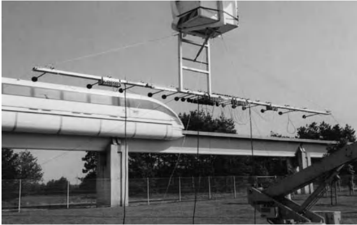
Abb. 6.31 Zehnfach verschachteltes lineares Schachtel-Array für zehn Frequenzbänder zwischen 125 und 8000 Hz. Horizontale Ausrichtung erlaubt die Lokalisierung horizontal verteilter Quellen und die Mitführung des Fokus bei der Auswertung. 3
