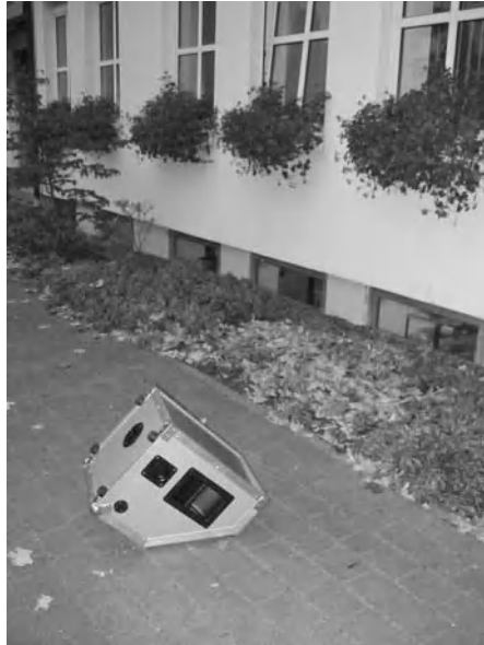
Abb. 4.28 Lautsprecher zur Messung der Schalldämmung von Außenbauteilen (Bild: Straten-schulte)
