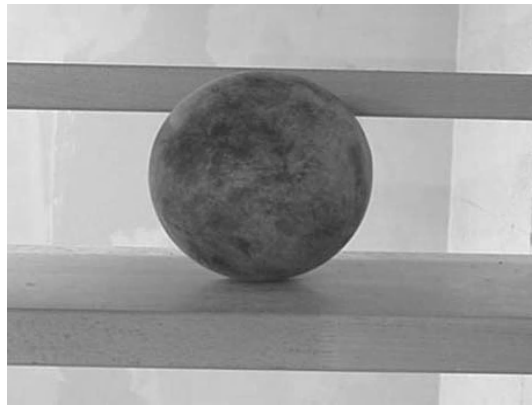
Abb. 4.36 Gummiball zur Anregung von Trittschall
