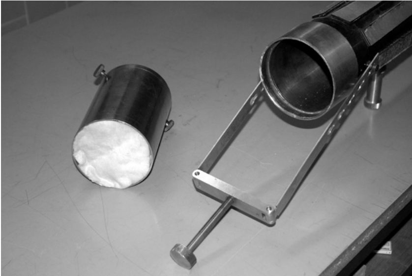
Abb. 10.3 Befüllter Objektträger zum Aufsetzen auf das ebenfalls rechts abgebildete Rohrende.
