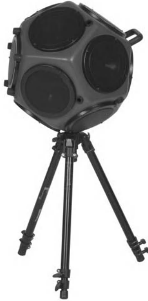
Abb. 4.24 Lautsprecher in Dodekaederform für bau- und raumakustische Messungen (Bild: Norsonic)
