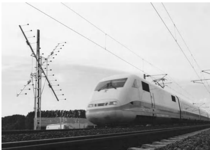
Abb. 6.19 X-Array zur zweidimensionalen Schallquellenortung an bewegten Fahrzeugen. 1
