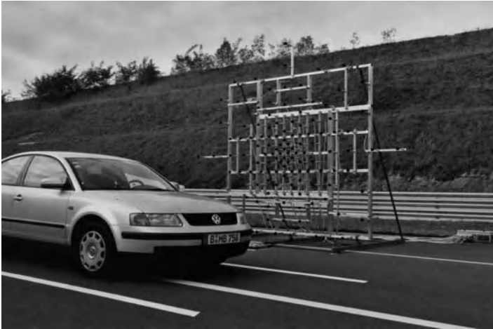
Abb. 6.32 Akustisch und aerodynamisch offenes Array mit 124 Mikrofonen zur Messung an Fahrzeugen. 4
