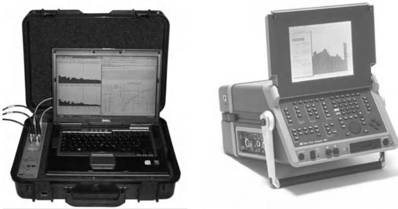
Abb. 4.23 Bauakustik-Messsysteme, links: PC-gestütztes Messsystem, rechts: Zweikanal-Echtzeitanalysator (Bilder: Norsonic)
