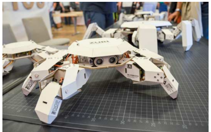
Mit Beinen und Gehäusen aus Papier und Pappe bewegen sich diese Zuri-Roboter.
