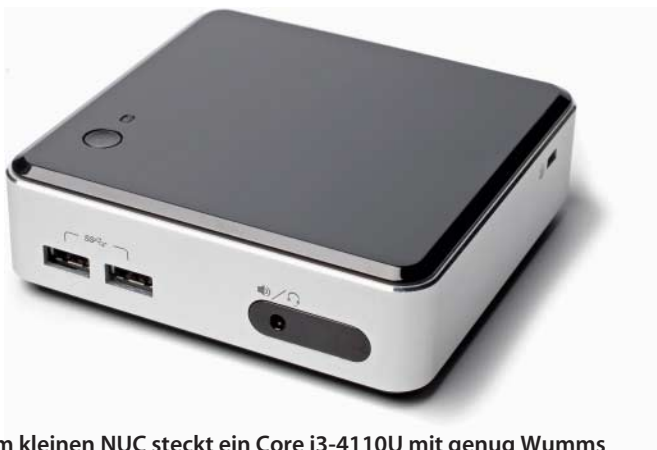
Im kleinen NUC steckt ein Core i3-4110U mit genug Wumms für alle Formate in 1080p – auch in Software.
