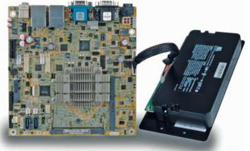
Akku am Mainboard: Das eKINO-BT übersteht Stromausfälle.
