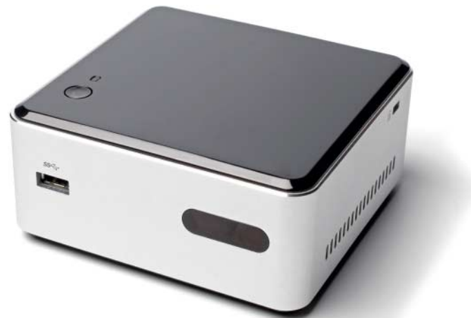
NUC DN 2880 FYKH: fast optimal für XBMC, schafft ohne Hardware-Beschleunigung aber höchstens Videos bis 720p
