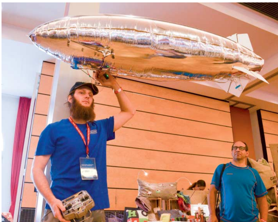
Nachahmer gesucht: Die Zeppelin-Hülle besteht aus Rettungsfolie und kann von jedermann mit dem Bügeleisen zu Hause selbst verschweißt werden. Anleitungen für den kompletten Nachbau gibt es im Netz.
