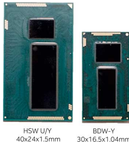
Haswell U/Y und Broadwell-Y (Core M) im Größenvergleich.
