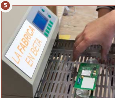
Die Leiterplatte in den Reflow-Ofen „Pizza-Ofen“ legen, Temperaturkurve einstellen und sieben Minuten backen.
