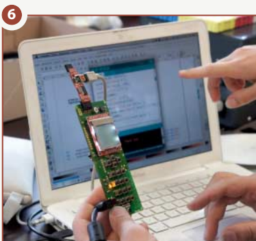
Das Display leuchtet, aber das heißt noch nichts. Falls der Mikrocontroller den GSM-Chip nicht ansprechen kann, stimmt etwas mit den Lötstellen nicht.
