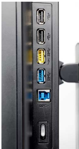
Der USB-Hub von Iiyamas B2888UHSU beherrscht den schnellen USB-3.0-Standard.
