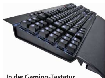
In der Gaming-Tastatur Corsair Vengeance K95 RGB stecken mechanische Schalter vom Typ Cherry MX RGB.
