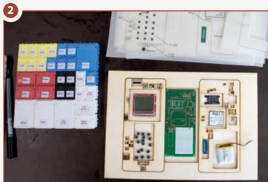
Zuerst 70 Handy-Bauteile aus dem „Mäuseklo“ (links) nehmen und gemäß Anleitung vorsortieren.
