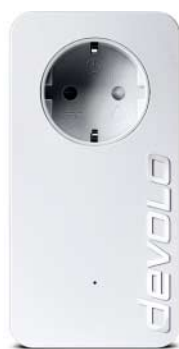
Der Adapter dLAN 1200+ von Devolo besitzt eine Durchschleif-Steckdose.
