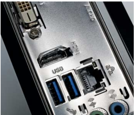
Beim HM24 Media-PC HM240015 wurden beim Zusammenbau die Kontaktfedern der I/O-Blende in die HDMI-Buchse gerammt.
