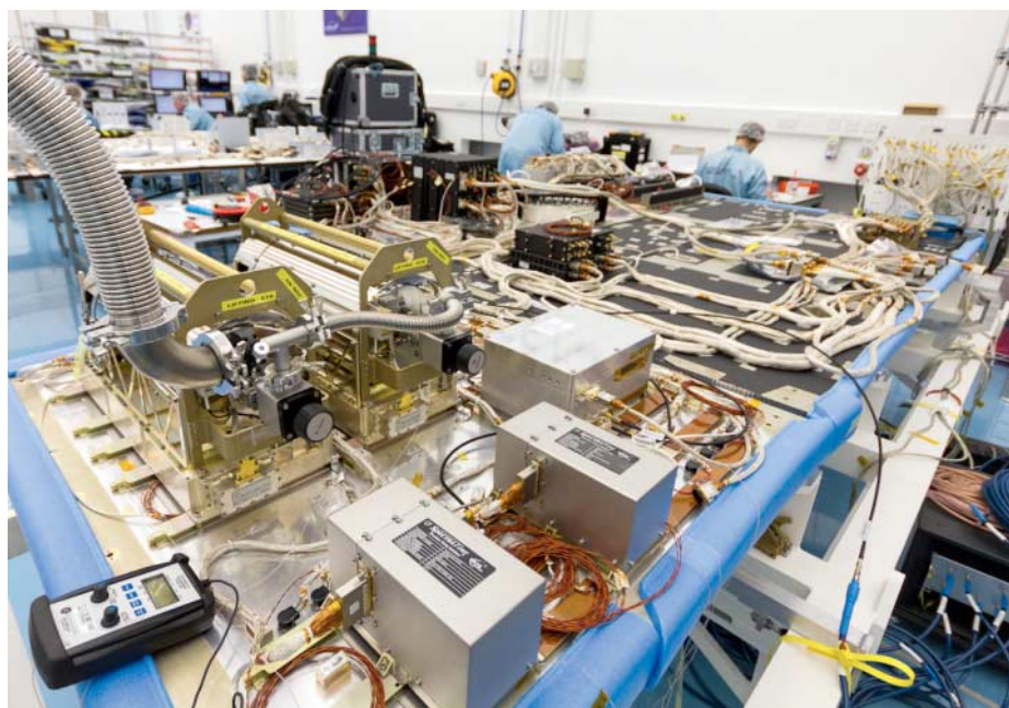
Das Atomuhren-Modul der Galileo-Satelliten. Im Vordergrund sind die beiden Rubidium-Uhren zu erkennen, dahinter die röhrenförmigen Wasserstoff-Maser-Uhren. Der Kasten in der Bildmitte ist die „Clock Monitoring and Control Unit“ (CMCU).
