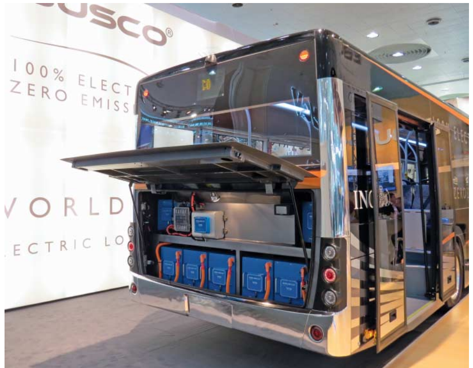
Der vollelektrische Stadtbuss YTP-2 von Ebusco bietet einhundert Fahrgästen Platz. Die Energie für 300 Kilometer Reichweite liefert ein 1,8 Tonnen schweres Lithium-Eisen-Phosphat-Akkupack im Heck.
