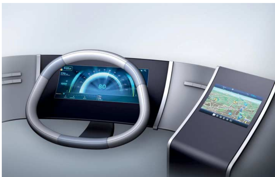
Bosch-Studie eines Lkw-Cockpits der Zukunft: Abhängig von der Fahrsituation werden auf den Displays nur die jeweils benötigten Informationen angezeigt. Herkömmliche Rückspiegel haben ausgedient und werden durch Kameras ersetzt.
