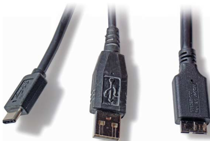
Größenvergleich: links der neue Typ-C-Stecker, in der Mitte der altbekannte Typ A und rechts der mit USB 3.0 eingeführte Micro-AB
