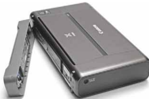
Den Akku (LK-62) des Canon iP110 muss man vor dem ersten Einsatz hinten an den Mobildrucker schrauben.
