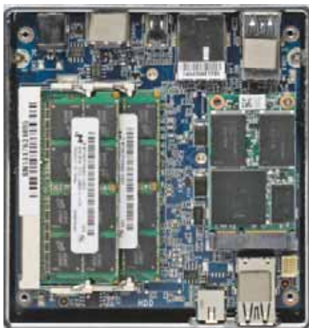
Im Gigabyte Brix ist gerade einmal Platz für zwei SO-DIMMs und eine mSATA-SSD. Das WLAN-Modul sitzt verdeckt unter dem SSD-Kärtchen.
