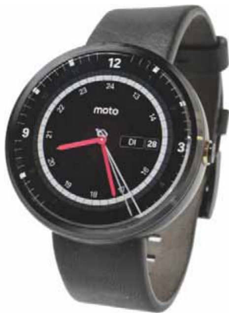
Das LC-Display der Motorola Moto 360 nimmt fast die gesamte Fläche des Gehäuses ein und wird von einem rund drei Millimeter breiten Rahmen eingefasst.
