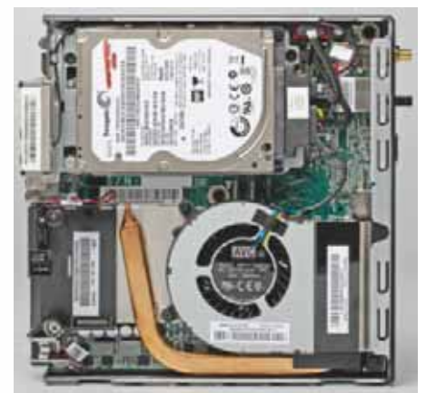
Bei Business-PCs achten die PC-Hersteller auf Wartungsfreundlichkeit: Die Festplatte des Lenovo ThinkCentre M73 Tiny sitzt auf einem Modul und lässt sich wie der CPU-Kühler mit wenigen Handgriffen lösen.
