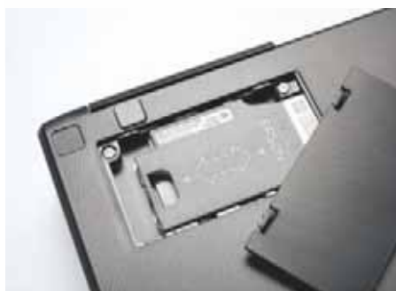
Der Resttintenbehälter des Epson WF-100W liegt schnell wechselbar hinter einer Klappe auf der Unterseite des Druckers. Ein Ersatzbehälter kostet rund fünf Euro.
