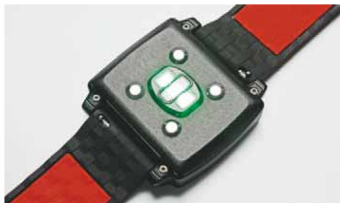
Das Basis Peak misst permanent Puls, Temperatur und Hautwiderstand.
