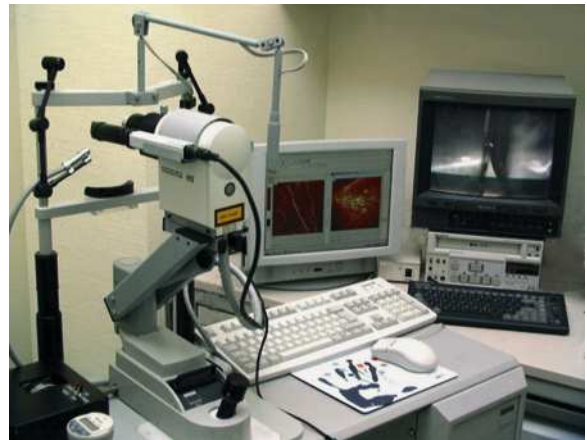
Abb. 6.3 Rostocker Laser-Scanning-Mikroskop (RLSM) auf der Basis des Heidelberg-Retina-Tomographen HRT II mit Objektivadapter und Videokontrollsystem zur Korneapositionierung.
