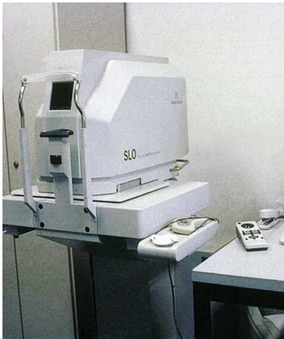
Abb. 16.3 SLO der Firma Rodenstock, hier dargestellt in einer Version, die auch die Fundusperimetrie erlaubt.
