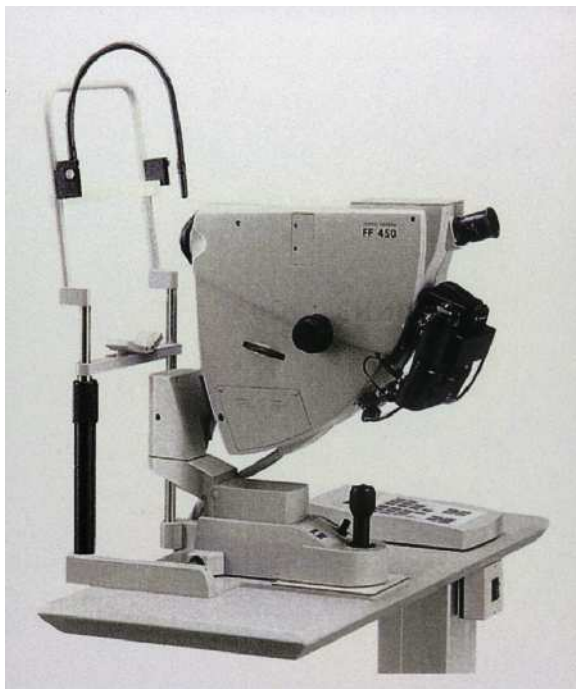
Abb. 16.1 Funduskamera der Firma Zeiss (Beispiel) mit angeschlossenem Body zur photographischen Angiographiedokumentation.
