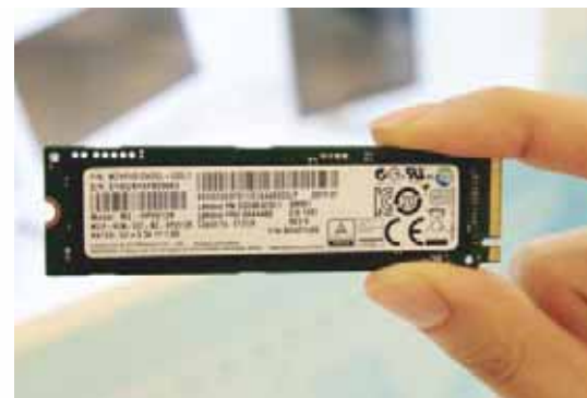
Via PCIe 3.0 x4 soll die Samsung SM951 über 2 GByte/s schaufeln.
