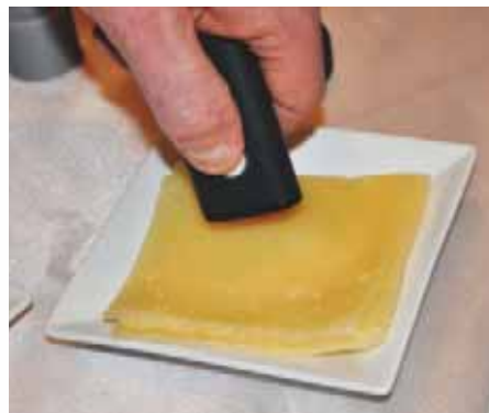
Das Mini-Spektrometer von SCIO ist nur 20 Gramm schwer.
