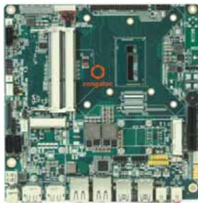
Auf dem Mini-ITX-Board conga-IC97 (links) und dem COM Express Modul conga-TC97 (rechts) sitzen bereits Prozessoren aus der Broadwell-Familie.
