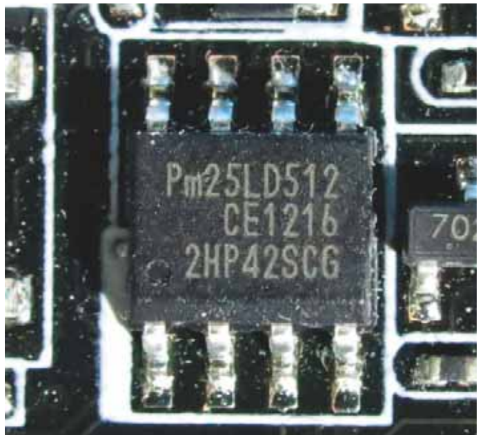
Der Software-Schreibschutz von SPI-Flashes für (UEFI-) BIOS-Code lässt sich oft austricksen.
