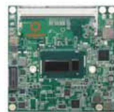
Auf dem Mini-ITX-Board conga-IC97 (links) und dem COM Express Modul conga-TC97 (rechts) sitzen bereits Prozessoren aus der Broadwell-Familie.
