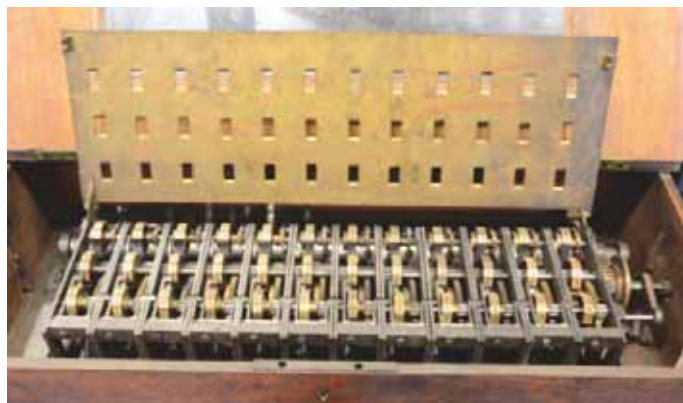
Ansicht auf die Walzen von Schwilgué's großer Rechenmaschine
