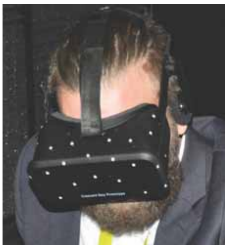
Der mit Infrarot-LEDs gespickte Crescent-Bay-Prototyp von Oculus beeindruckt mit nahezu perfektem Headtracking.
