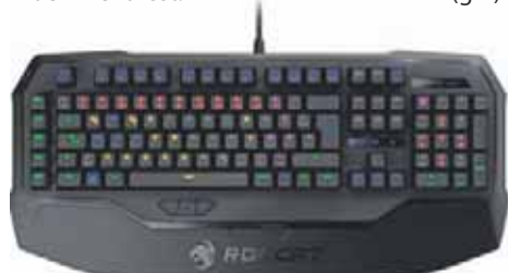
Auch Roccat will eine RGB-Tastatur anbieten. Bei der Ryos MK FX kann der Anwender die Hintergrundbeleuchtung jeder Taste einzeln umfärben.
