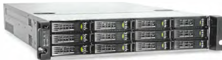
Der Storage-Server S1212M von Grafenthal nimmt zwölf Festplatten auf und lässt sich mit externen Boxen erweitern.
