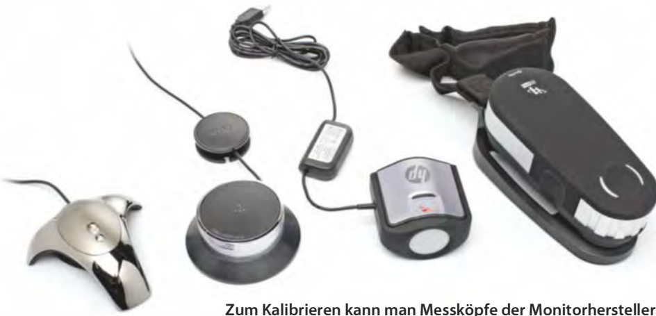
Zum Kalibrieren kann man Messköpfe der Monitorhersteller (LG und HP, Mitte) verwenden oder auf Colorimeter wie den Spyder 4 (links) sowie Photometer wie das i1 Pro 2 (rechts) zurückgreifen.
