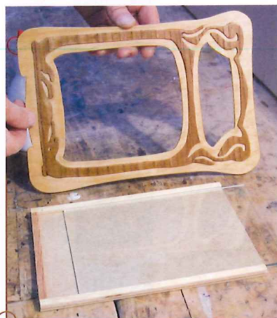
Hier wurde das Schmuckmotiv aus Rüsterfurnier gesägt und auf einen ungebeizten Birken-sperrholzrahmen geleimt.
