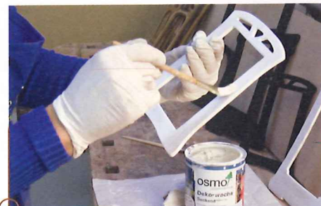
Dieser Rahmen hat eine lasierte Oberfläche mit Dekorwachs. Durch Abreiben mit einem Lappen nach dem Pinselauftrag entsteht der etwas durchscheinende Lasureffekt.
