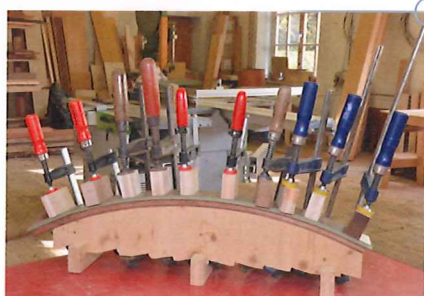
Dazu gehört dieser Zwingenigel, mit dem Misslinger die Querstücke der Glastür schichtverleimt.
