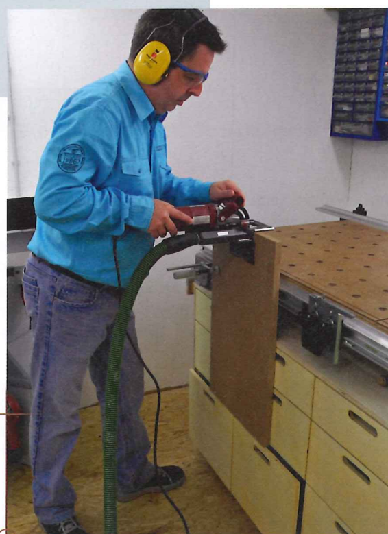
Leicht herausgezogene Schubkästen dienen als integrierter Bankknecht zur Abstützung des Werkstückes in verschiedenen Höhen.
