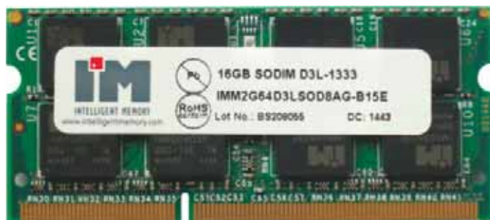
SO-DIMMs von Intelligent Memory mit 16 GByte Kapazität laufen in kompakten Broadwell-Rechnern, die sonst mit weniger Speicher auskommen müssen.
