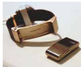
Ohne Armband wird aus dem Huawei Talkband B2 ein Bluetooth-Headset.
