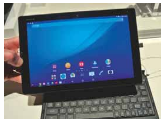
Das Android-Tablet Sony Xperia Z4 ist nicht nur leicht und dünn, sondern auch wasserdicht. Das optionale Tastaturdock macht es zum Netbook-Ersatz.
