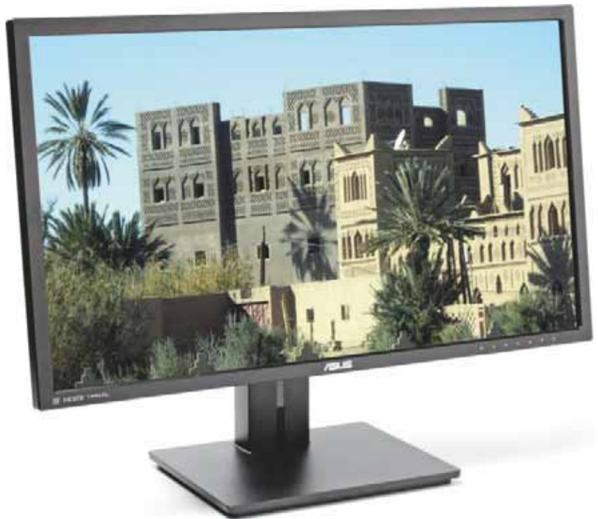
Damit der Asus PB287Q 4K-Auflösung ruckelfrei mit 60 Hz anzeigt, muss er an eine Grafikkarte mit DisplayPort 1.2 angeschlossen sein.
