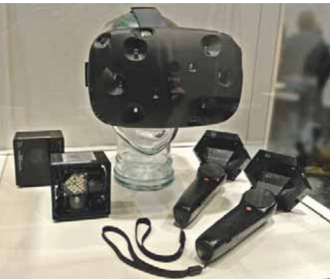
Valve überraschte mit Vive, einer VR-Brille mit Hand-Controllern und Laser-Trackern, deren Präzision bisherige Systeme in den Schatten stellt.
