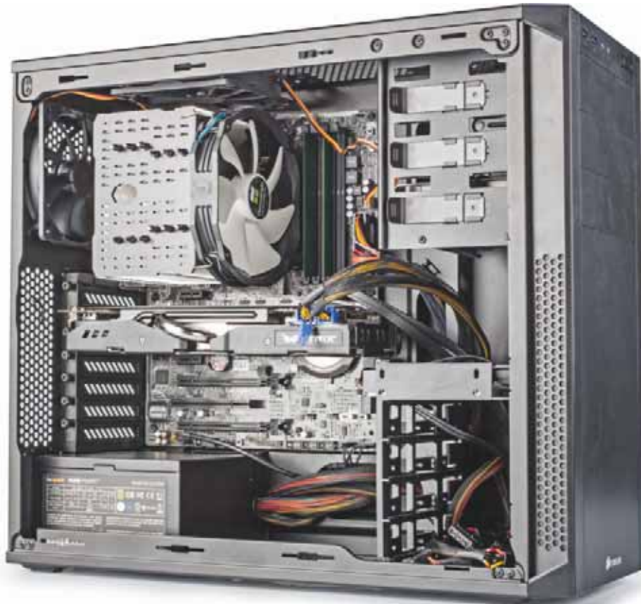
Dem Prozessor haben wir einen großen Kühler mit einem leisen Lüfter spendiert.
