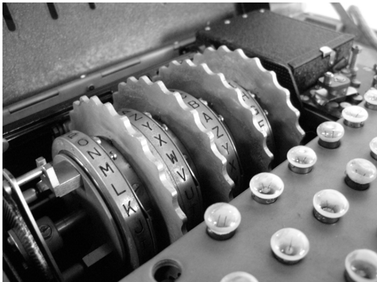
Abbildung 6.3 Detailaufnahme der ENIGMA Modell A/27 (Baujahr 1937) aufgenommen im Flieger-Flab-Museum in Dübendorf, bei der die drei eingesetzten Walzen zu sehen sind. Ganz links befindet sich die Umkehrwalze. Bei dieser ENIGMA sind die Kontakte der Walzen mit Buchstaben anstatt Zahlen beschriftet.
