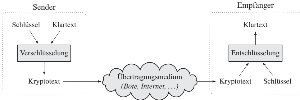
Abbildung 1.8 Dieses Kommunikationsschema zeigt den Kommunikationsschritt, bei dem die Übertragung einer verschlüsselten Nachricht gezeigt wird. Um den Klartext zu verschlüsseln oder den Kryptotext zu entschlüsseln brauchen beide Kommunikationspartner zusätzlich einen gemeinsamen geheimen Schlüssel.
