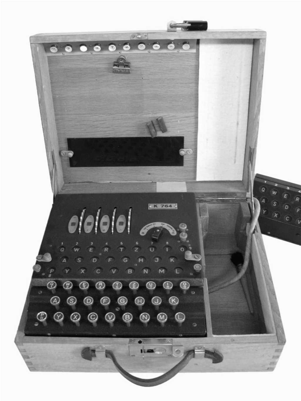
Abbildung 6.1 Fotografie einer ENIGMA Modell A/27 (Baujahr 1937) aufgenommen im Flieger-Flab-Museum in Dübendorf. Gut zu sehen ist die Tastatur und das Lampenfeld oberhalb der Tastatur.
