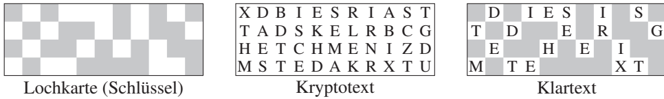
Abbildung 1.13 Das Kryptosystem RICHELIEU. Links ist eine Lochkarte für einen Klartext mit zwanzig Buchstaben abgebildet. Wird die Lochkarte auf den Kryptotext gelegt, der in der Mitte dargestellt ist, erhält man den Klartext, der rechts abgebildet ist.
